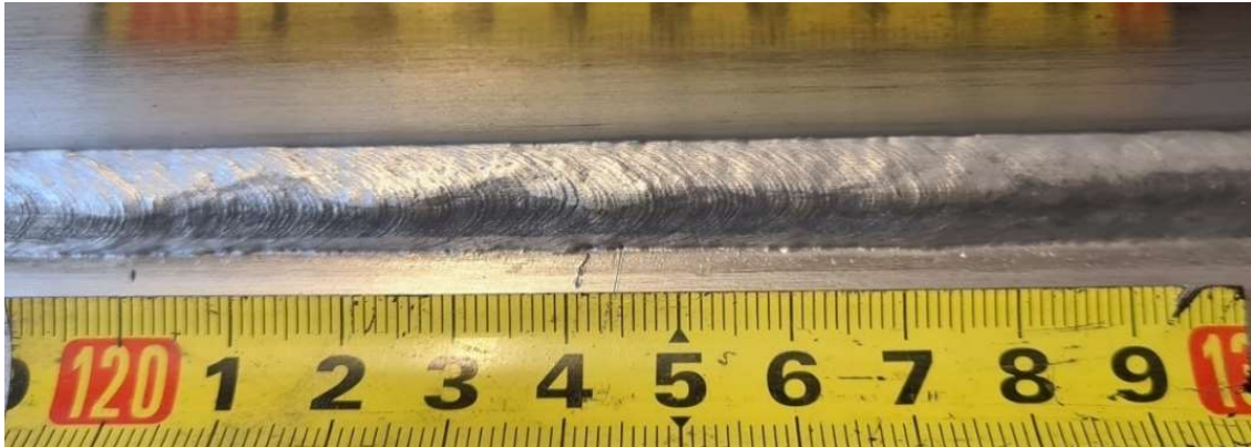
Slika 32. Izgled zavara uzorka 2B nakon čišćenja
