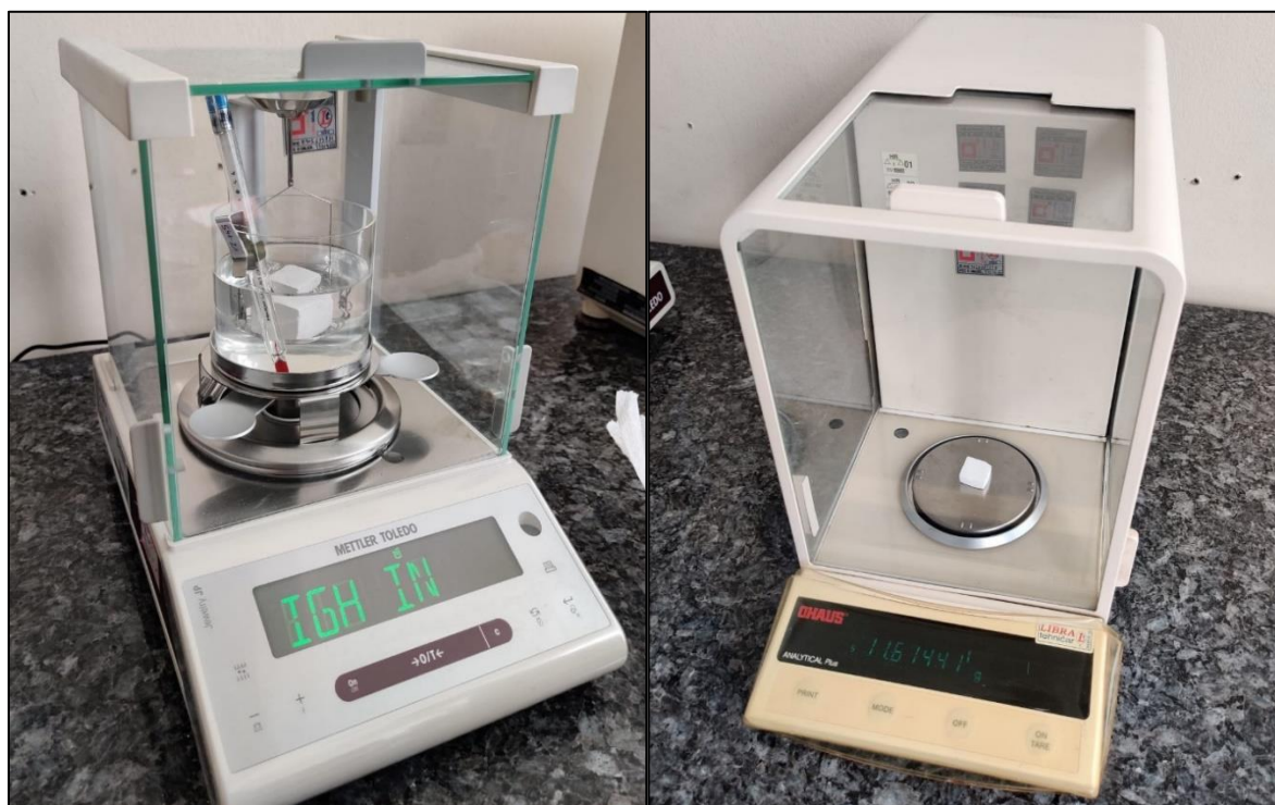
Slika 25. Analitička vaga Ohaus AP250D
