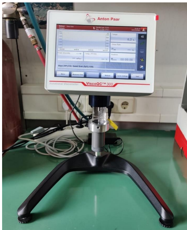
Slika 20. Rotacijski viskozimetar – Anton Paar ViscoQC 300
