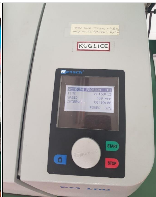
Slika 19. Režim miješanja kugličnim mlinom
