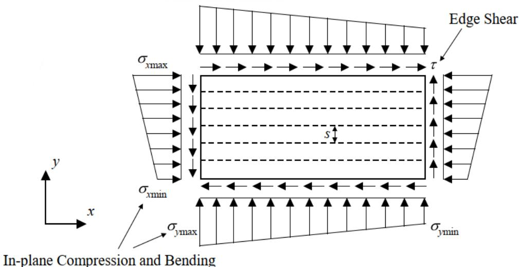
**Slika 6-22 Moguća raspodjela naprezanja na ukrepljenom panelu [22]**
