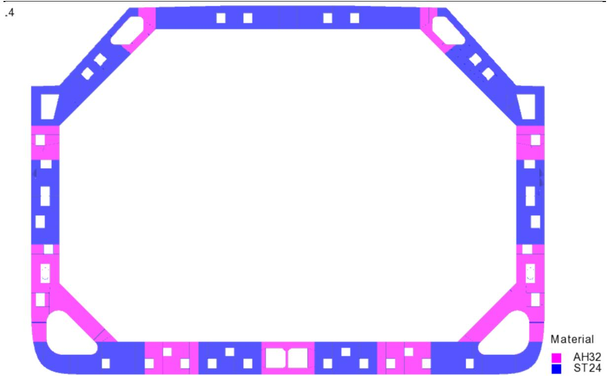
Slika 5-5 Raspored različitih materijala po poprečnom presjeku rebra
