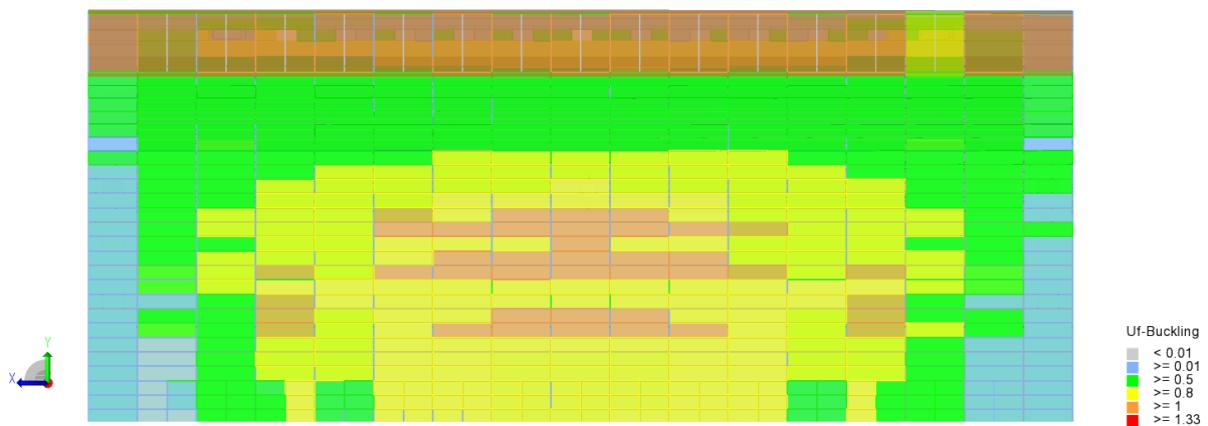
Slika 6-24 Prikaz faktora iskoristivosti pojedinih dijelova konstrukcije za slučaj izvijanja za slučaj opterećenja L4-tlocrt
