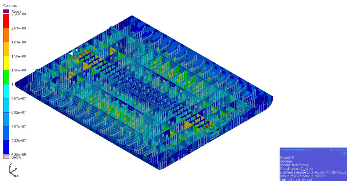
**Slika 6-11 VonMises naprezanja u roštilju dvodna [Pa]**
