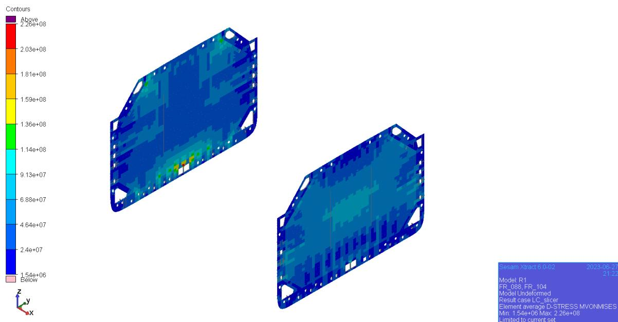
**Slika 6-9 VonMises naprezanja na koferdamskim pregradama [Pa]**
