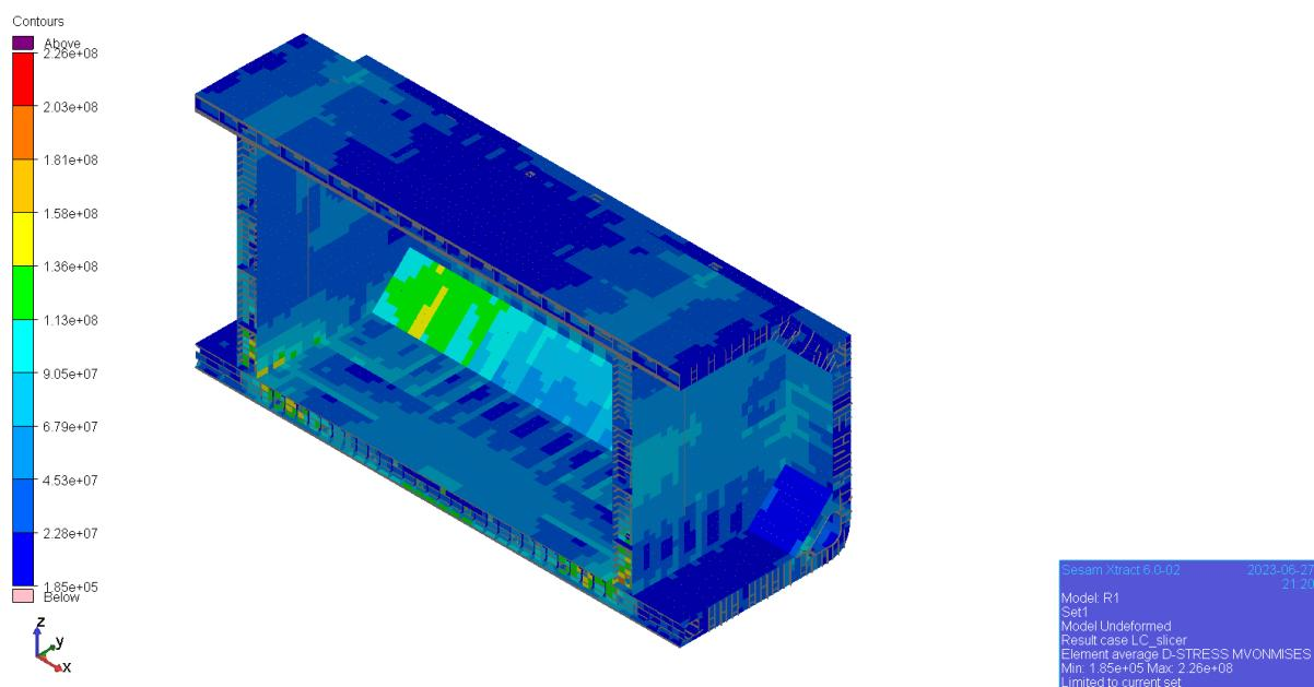
**Slika 6-5 VonMises naprezanja na presjeku  $y = 0$  (centerline) [Pa]**
