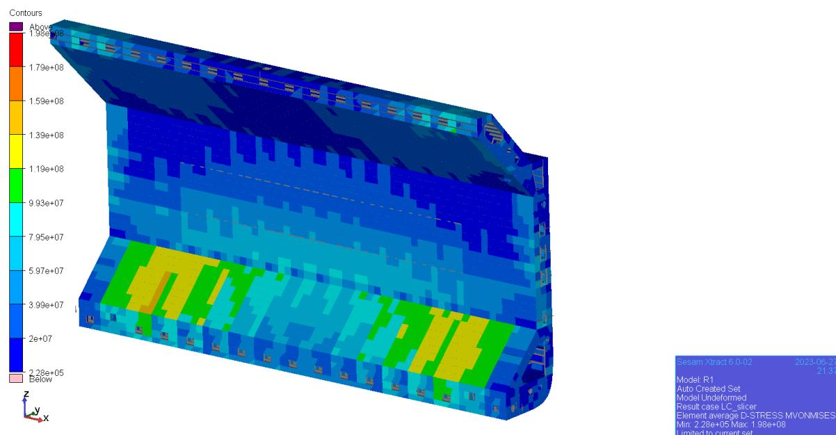
**Slika 6-12 VonMises naprezanja u području uzvojnog tanka [Pa]**
