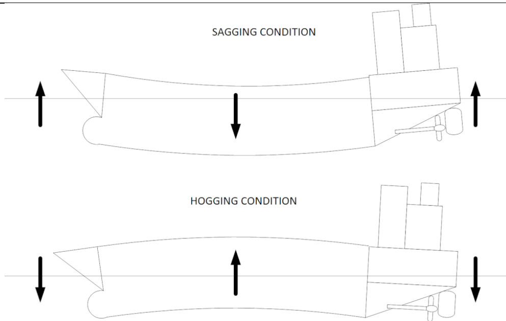
Slika 5-13 Prikaz smjera djelovanja rezultante smične sile zbog raspodjele masa po brodu [17]
