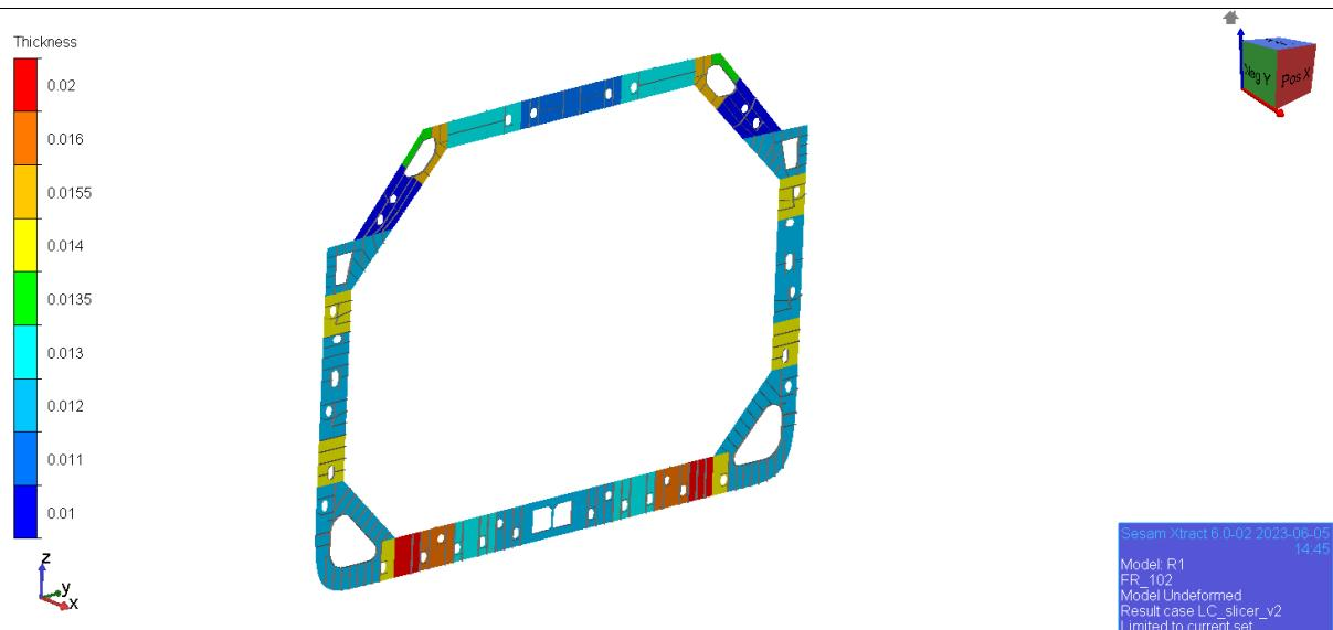
**Slika- B-III Debljine na tipičnom rebru [m]**
