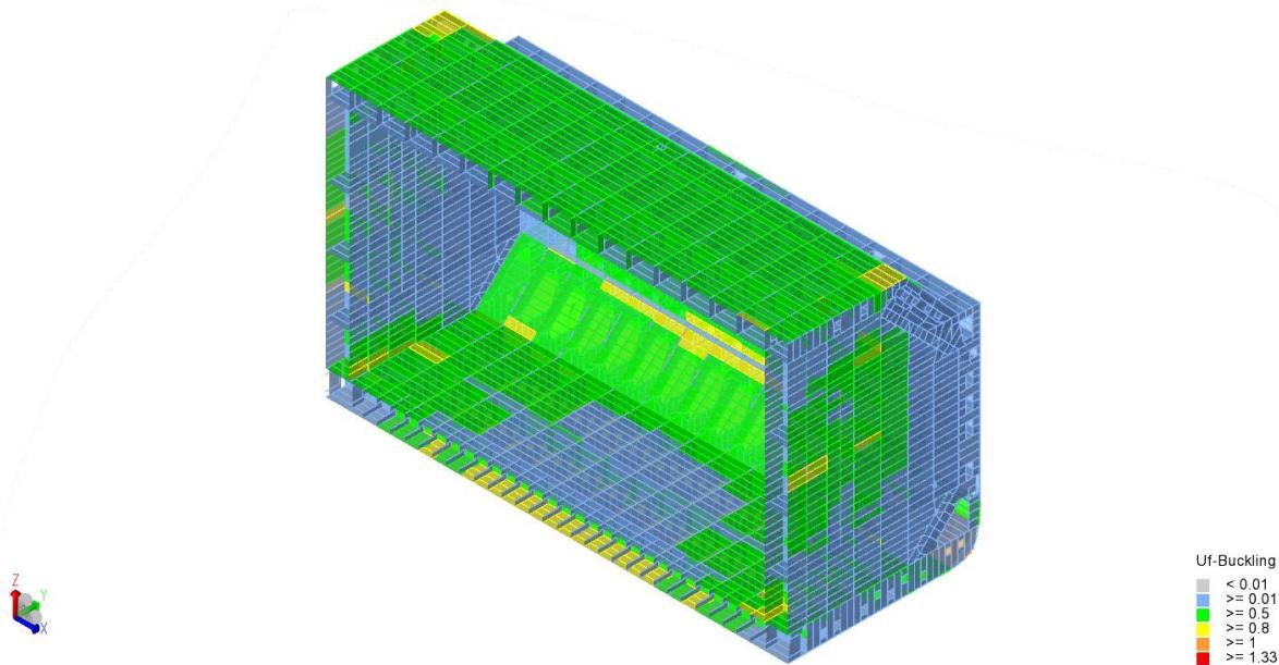
Slika 6-23 Prikaz faktora iskoristivosti pojedinih dijelova konstrukcije za slučaj izvijanja za slučaj opterećenja L4
