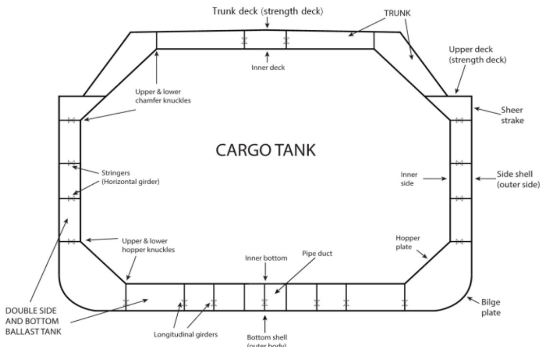
Slika 2-4 Nomenklatura tipičnog glavnog rebra tankera membranskog oblika [9]
