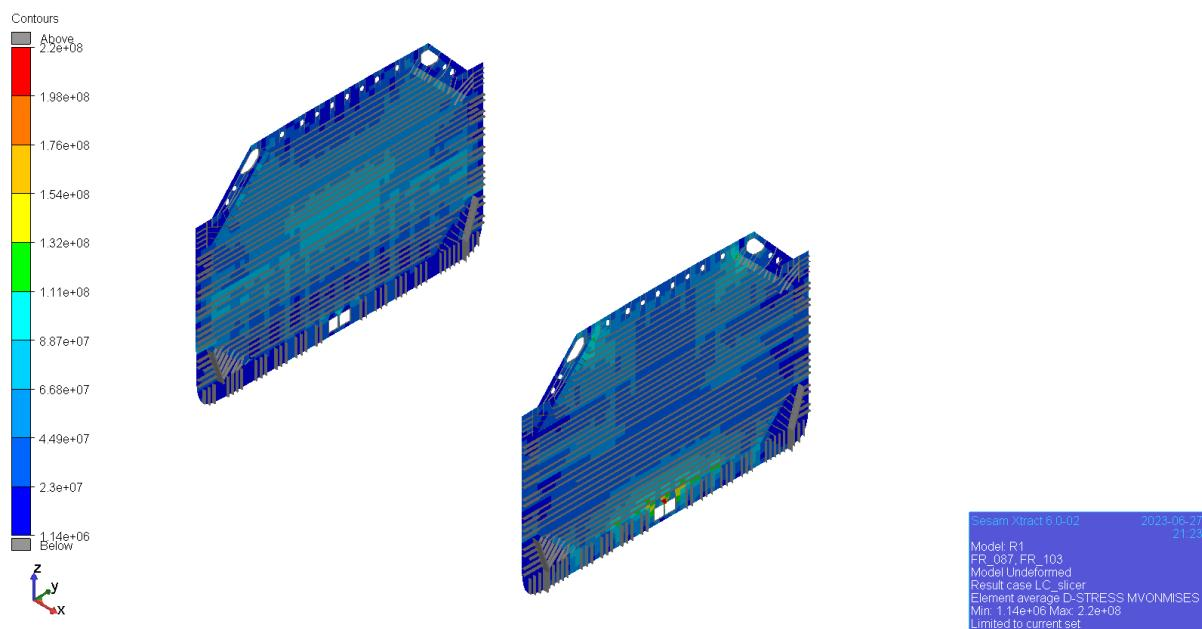
**Slika 6-8 VonMises naprezanja na vodonepropusnim pregrada [Pa]**
