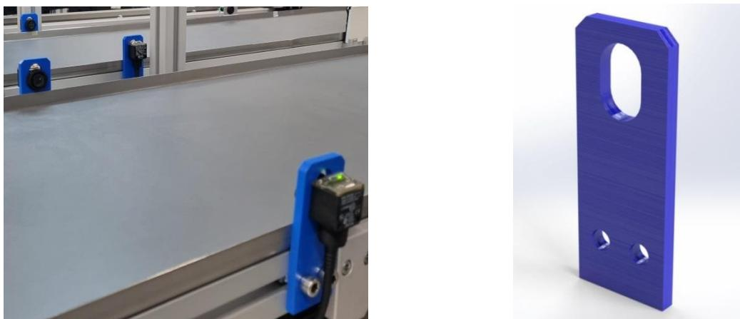
Slika 55. Prikaz instaliranog fotoelektričnog senzora
