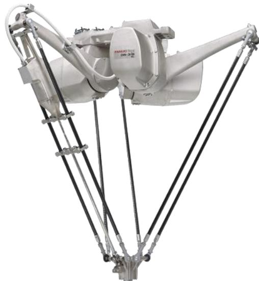
Slika 72. Fanuc delta-robot DR-3iB [22]
