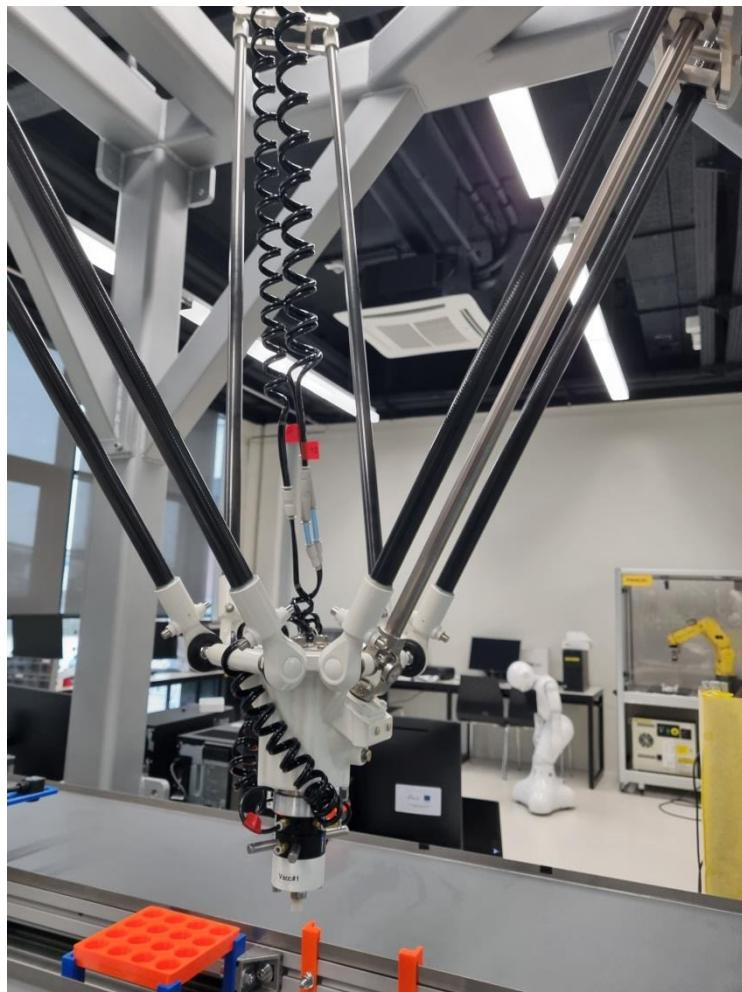
**Slika 85. Prikaz spiralnih pneumatskih cijevi**
