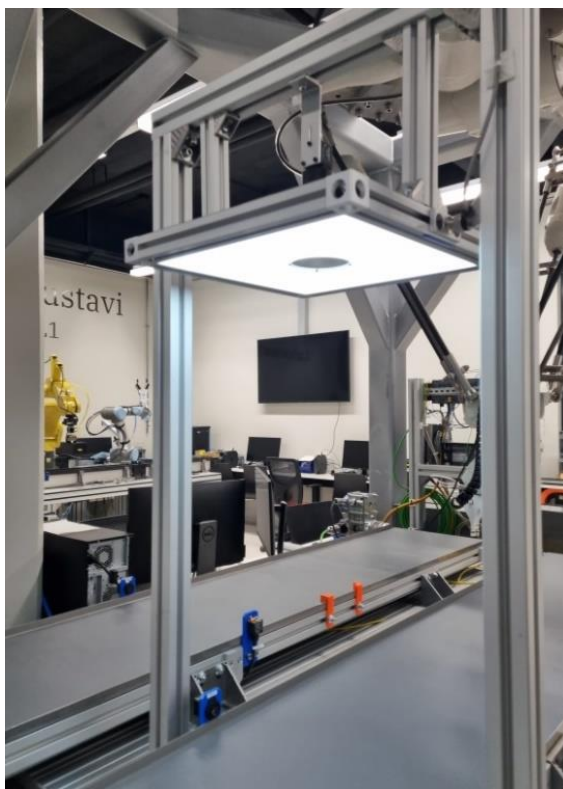
Slika 79. Prikaz instalirane Machine Vision rasvjete i Fanuc-kamere
