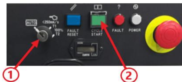
Slika 111. Postavljanje robota u automatski način rada
