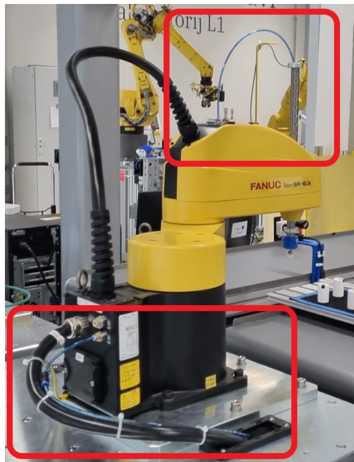
Slika 24. Prikaz spajanja pneumatike na Fanuc robota SR-6iA
