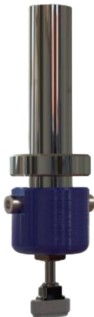
Slika 27. CAD model prihvatnice vakuumske hvataljke
