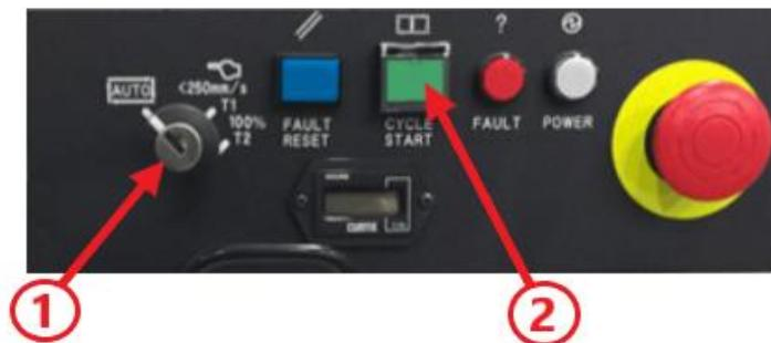
Slika 111. Postavljanje robota u automatski način rada
