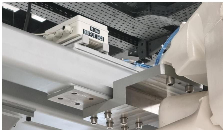
Slika 59. Prikaz vanjske *output* kutije za delta-robot M-3iA
