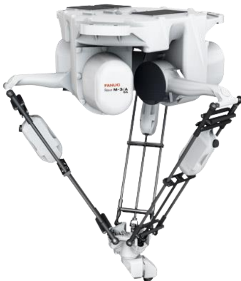
Slika 47. Fanuc delta-robot M-3iA [13]
