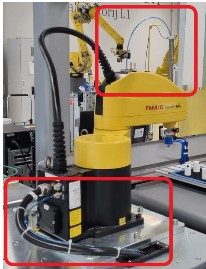
Slika 24. Prikaz spajanja pneumatike na Fanuc robota SR-6iA
