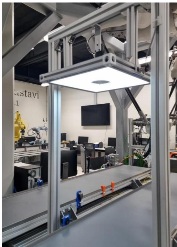
Slika 79. Prikaz instalirane *Machine Vision* rasvjete i Fanuc-kamere
