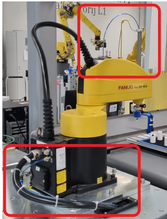
Slika 24. Prikaz spajanja pneumatike na Fanuc robota SR-6iA
