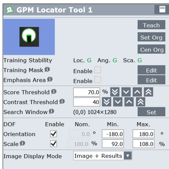
Slika 93. Prozor za učenje karakteristika predmeta rada - robot DR-3iB
