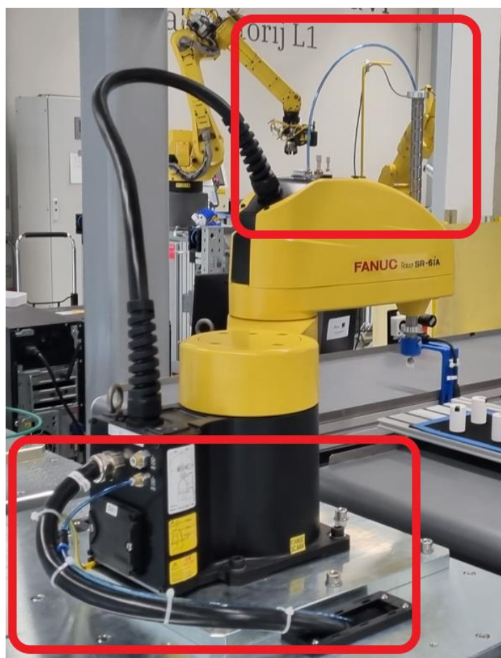
Slika 24. Prikaz spajanja pneumatike na Fanuc robota SR-6iA
