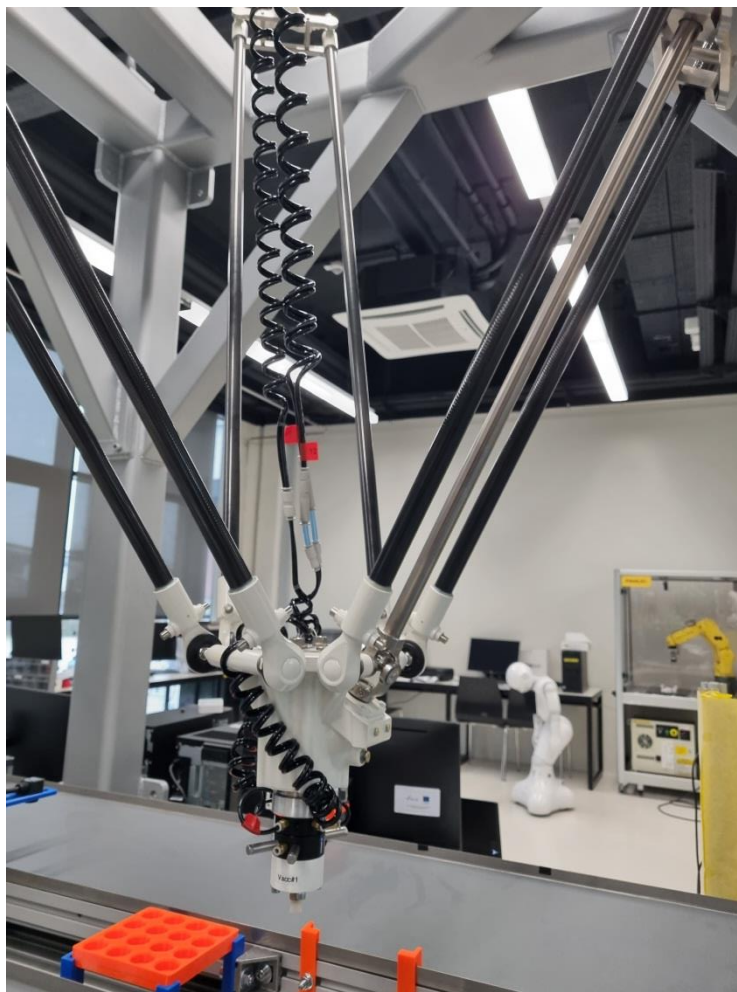
Slika 85. Prikaz spiralnih pneumatskih cijevi
