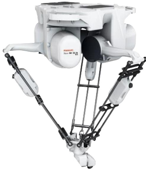
Slika 47. Fanuc delta-robot M-3iA [13]
