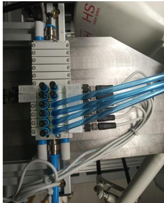
**Slika 84. Prikaz instaliranog pneumatskog bloka s razvodnicima**
