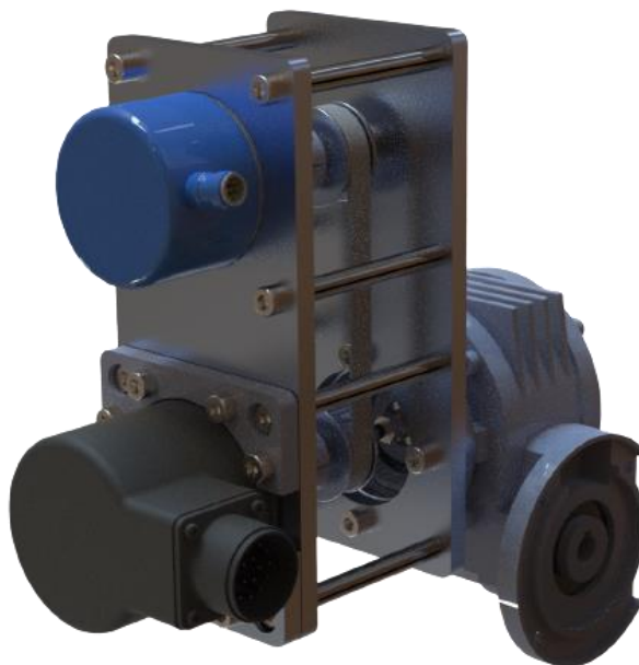
Slika 52. CAD model konstrukcije za montažu enkodera
