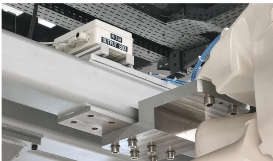
Slika 59. Prikaz vanjske output kutije za delta-robot M-3iA
