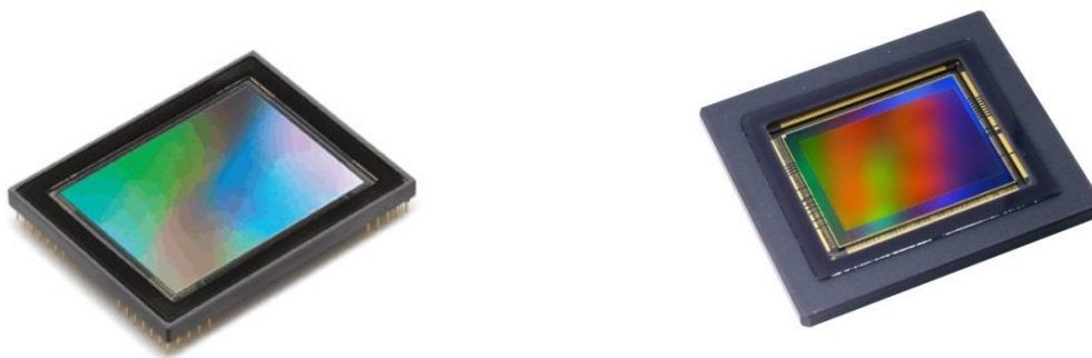
Slika 6. Prikaz CCD (lijevo) senzora slike [3] i CMOS (desno) senzora slike [4]
