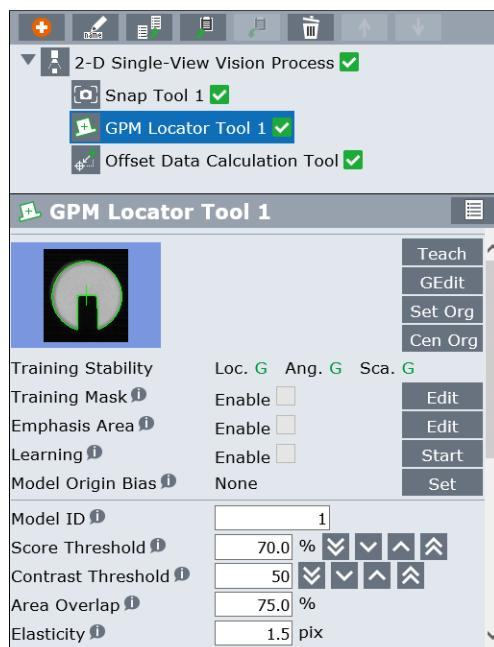
**Slika 41.** Prozor za učenje karakteristika predmeta rada - robot SR-6iA
