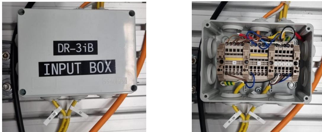
Slika 82. Prikaz vanjske *input* kutije za delta-robot DR-3iB
