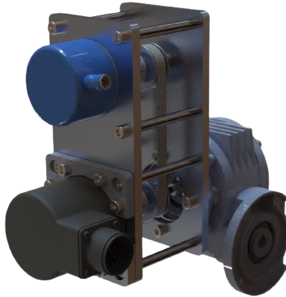
Slika 52. CAD model konstrukcije za montažu enkodera
