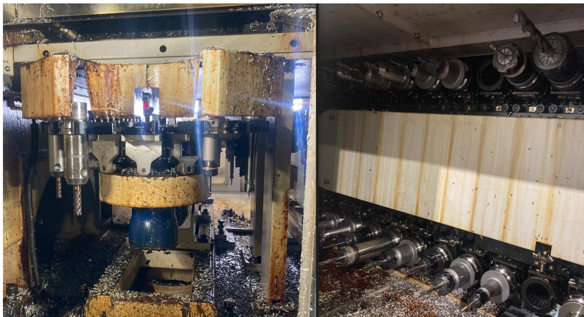
Slika 5. Kružno (lijevo) i lančano (desno) spremište glodala i svrdla - GOC
