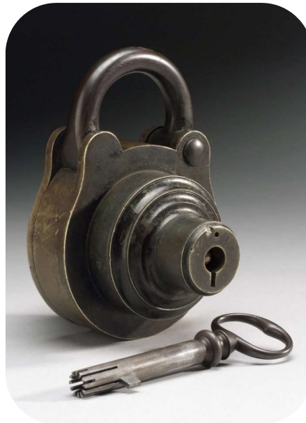
Slika 2.6 - Braham-ova cjevasta polužna brava na lokotu, ~1790.g [06]
