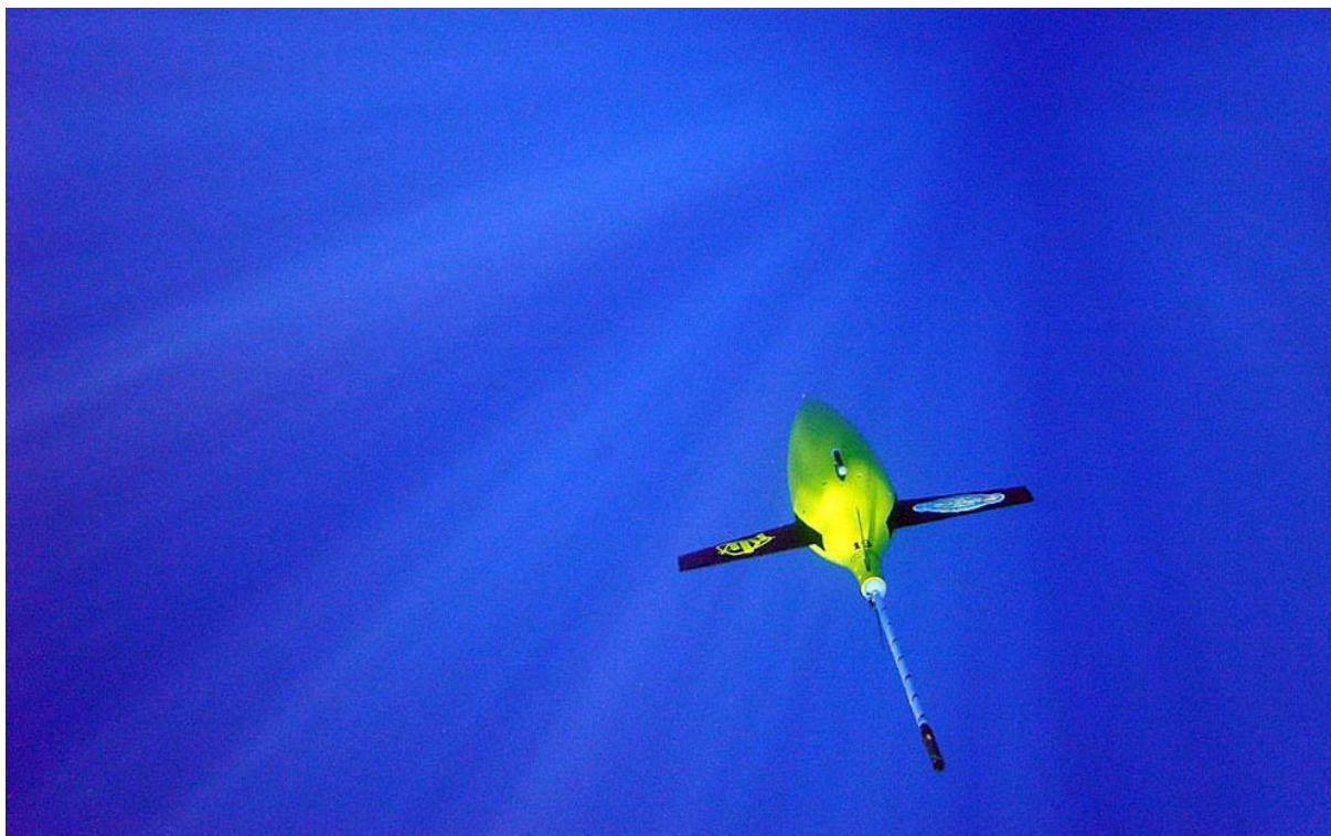
Slika 2.5 Autonomno podvodno vozilo Seaglider [6]
