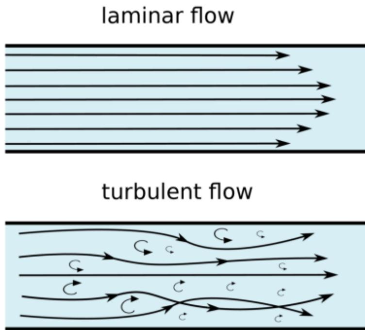
Slika 2.7 Usporedba laminarnog i turbulentnog strujanja [1]
