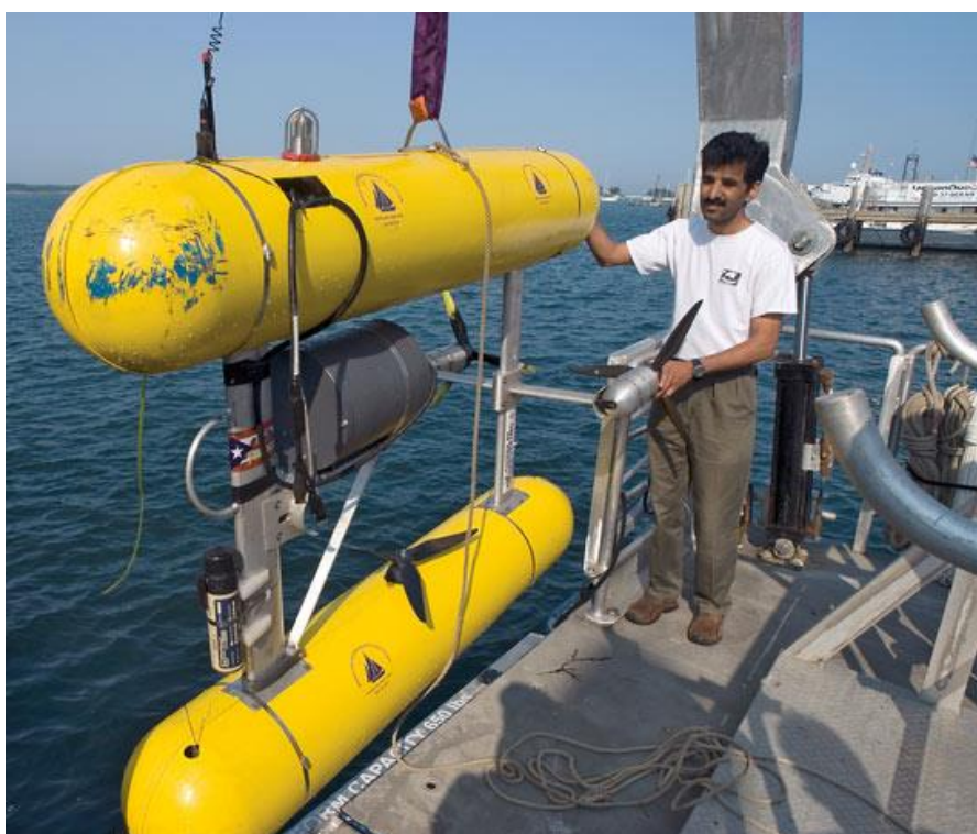
Slika 2.3 Autonomno podvodno vozilo SeaBED [4]
