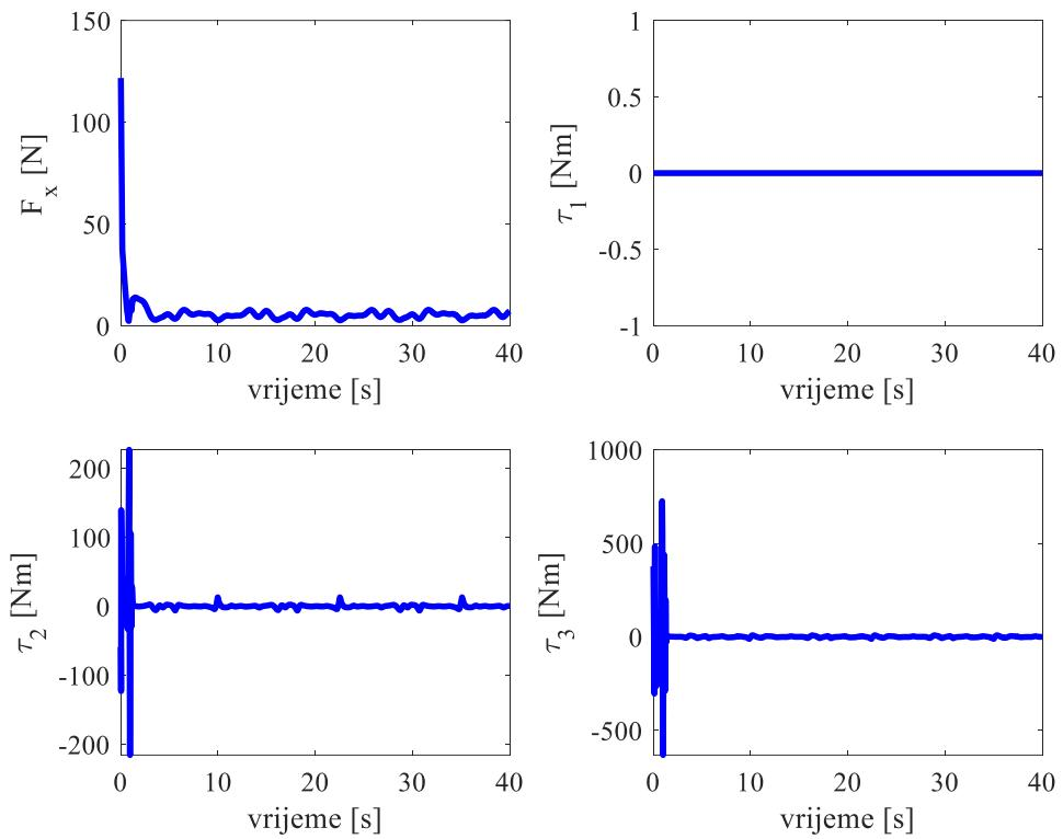
**Slika 5.27 Upravljačke varijable vozila za robusni regulator**
