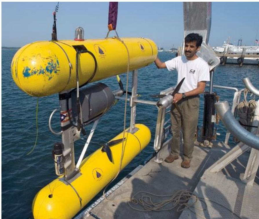
Slika 2.3 Autonomno podvodno vozilo SeaBED [4]
