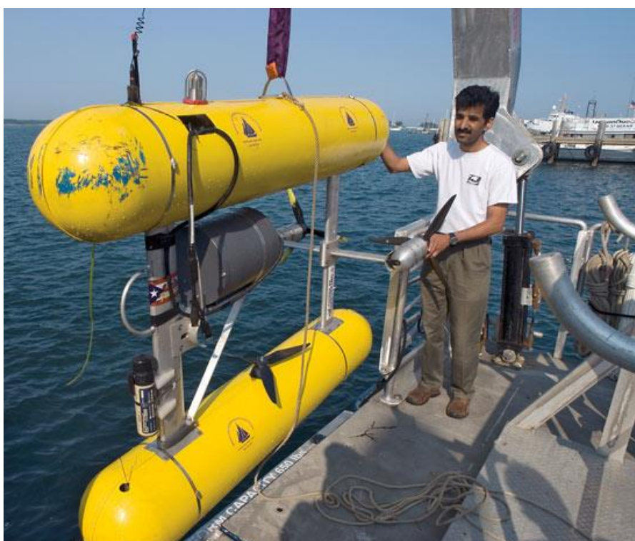
Slika 2.3 Autonomno podvodno vozilo SeaBED [4]
