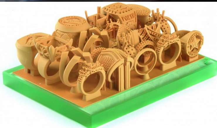
Slika 14. Primjer proizvoda izrađenih DLP tehnologijom [14]
