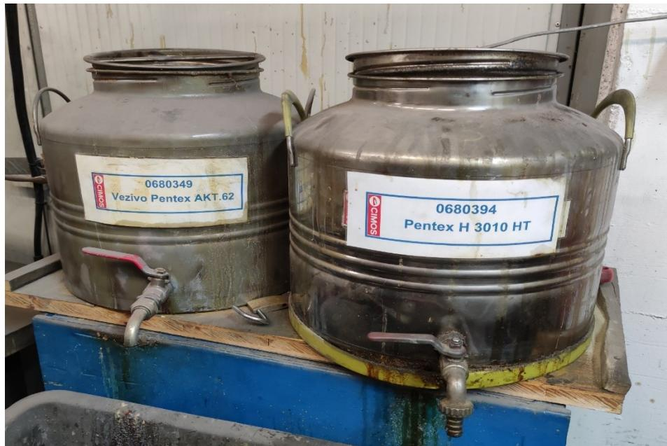
**Slika 56. Veziva za izradu pješčanog kalupa**
