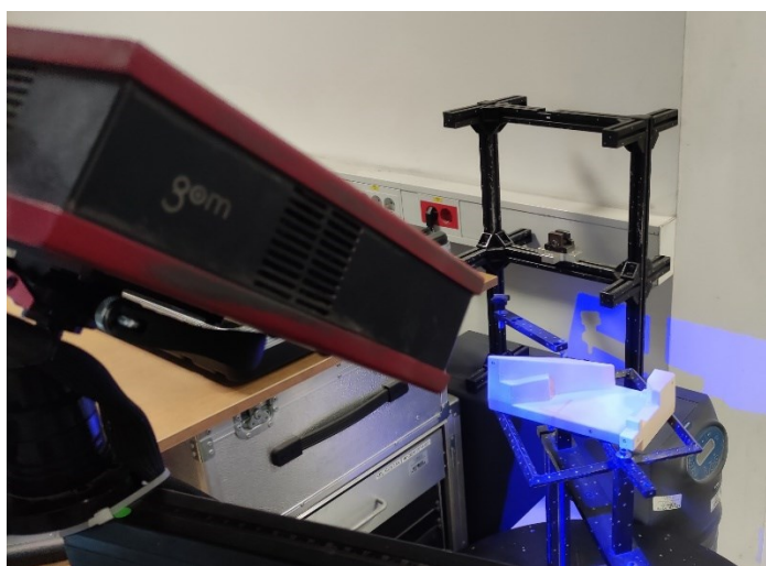
Slika 45. Proces 3D skeniranja modela
