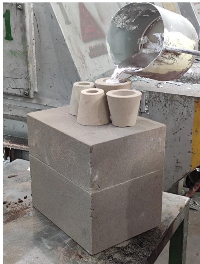
Slika 62. Lijevanje u kalup
