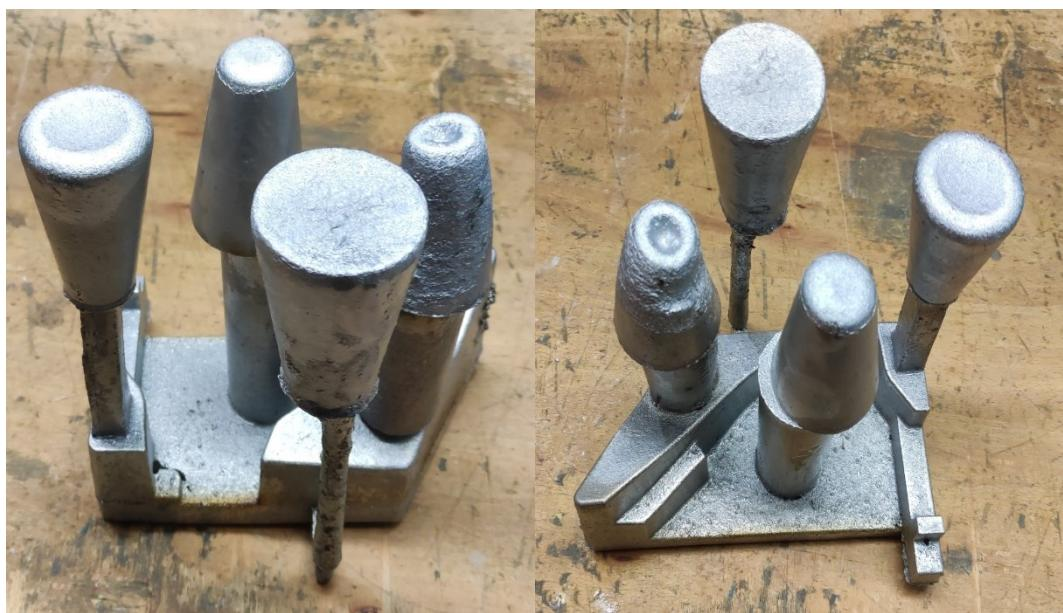
Slika 63. Naprava nakon vodenja iz kalupa
