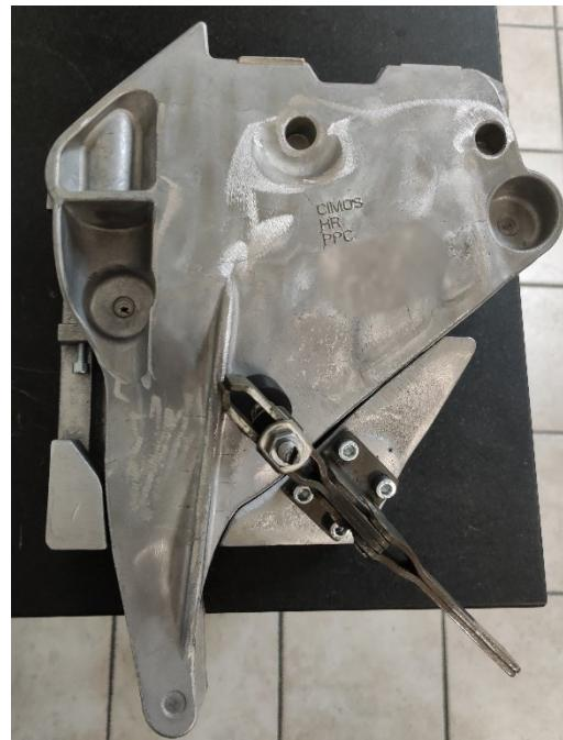
Slika 69. Provjera nalijeganja nosača motora na napravu
