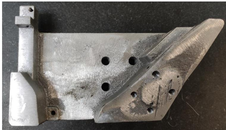
Slika 67. Mehanički obrađena naprava
