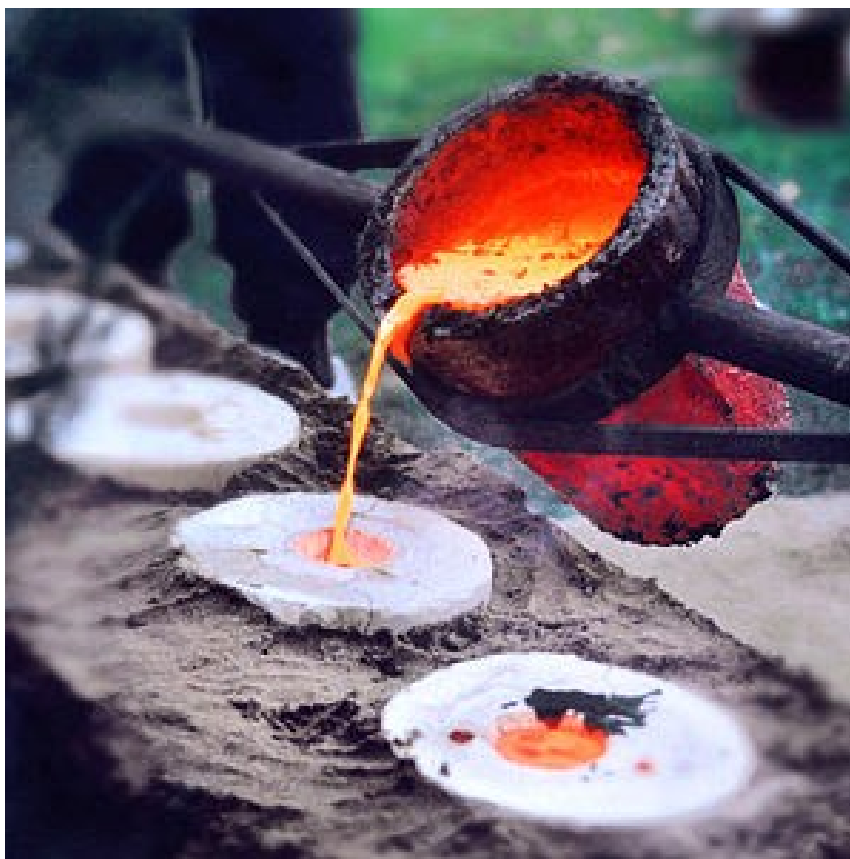
Slika 21. Lijevanje u kalupe [17]
