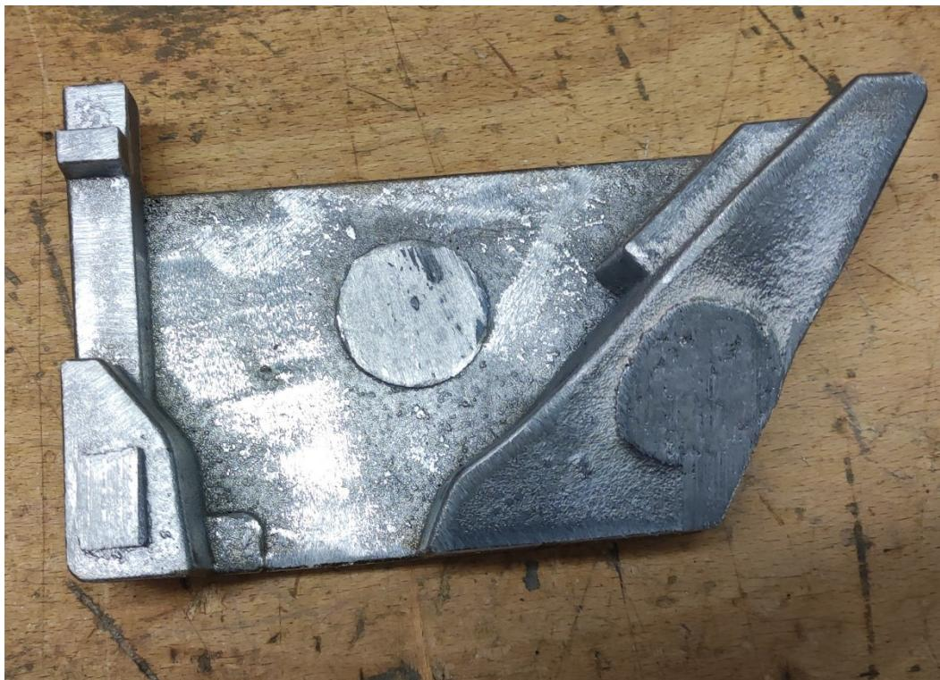
**Slika 64. Naprava nakon vađenja iz kalupa i uklanjanja uljevnog sustava**
