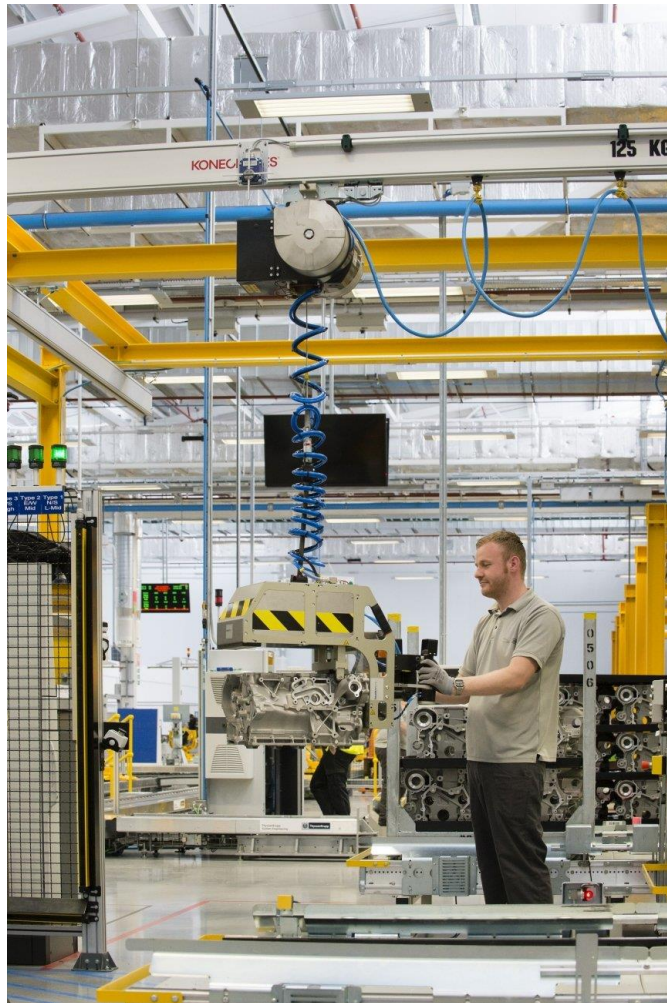
Slika 8. Radnik koji diže blok motora balanserom [20]
