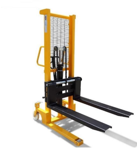
Slika 11. Manualni hidraulični paletni viličar slagač [23]
