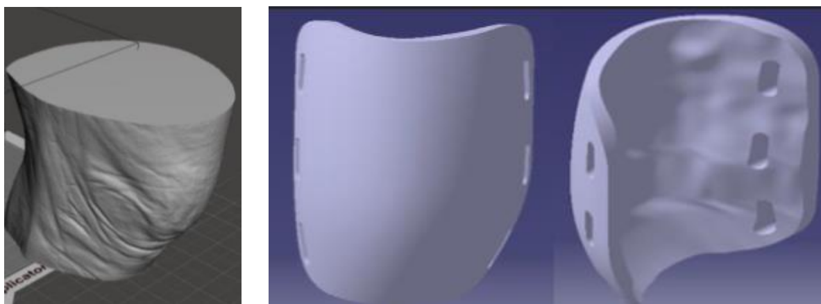
Slika 11. a) Model koljena generiran 3D skeniranjem; b) konstruirani 3D model štitnika [17]
