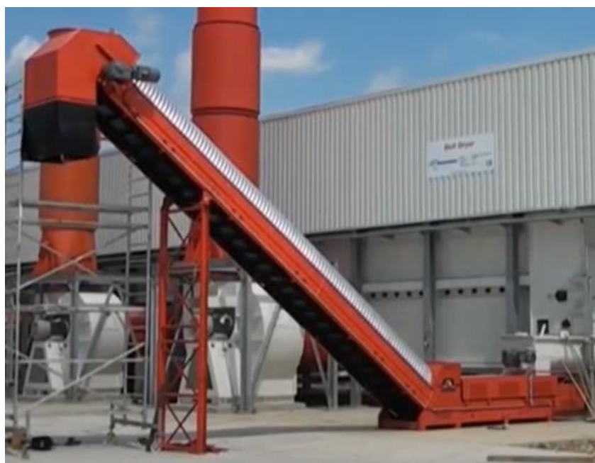
Slika 22. Konvejer za drvenu sječku u termoelektrani Slatina [16]
