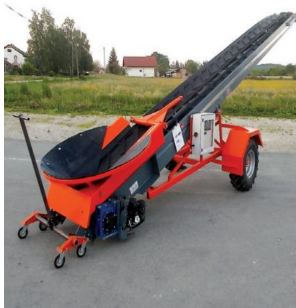
Slika 7. Mobilni trakasti konvejer s gumenom trakom [8]
