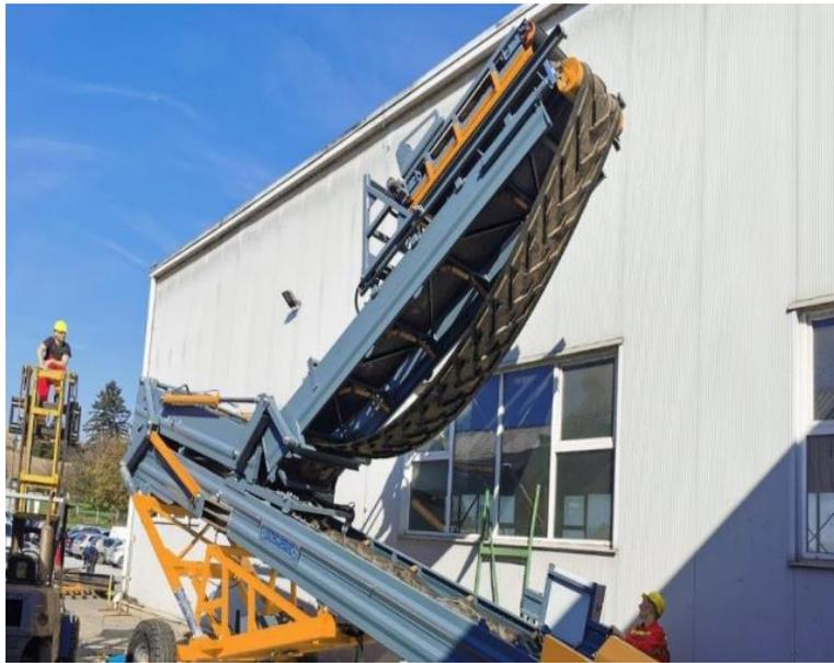
**Slika 8. Preklopni konvejer s gumenom trakom [8]**
