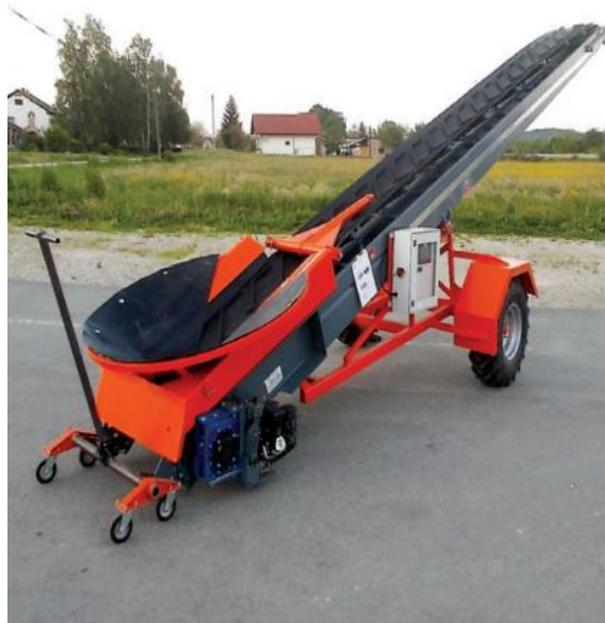
**Slika 7. Mobilni trakasti konvejer s gumenom trakom [8]**
