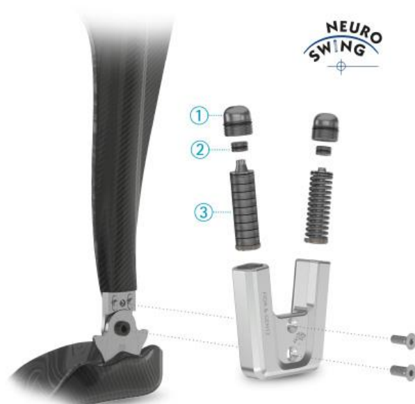
Slika 26. Komponente NEURO SWING dinamičkog elementa [66]
