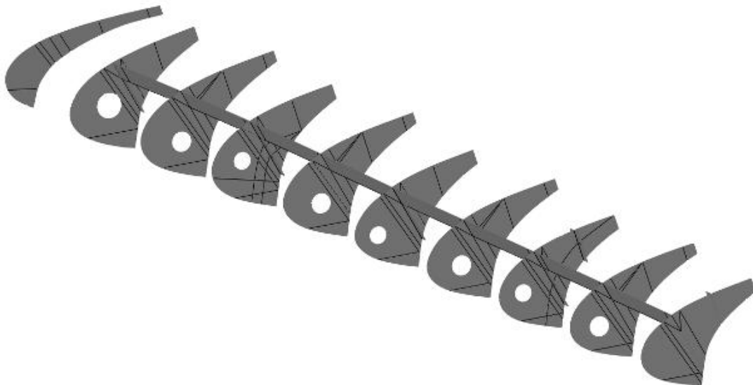
Slika 3.20 Model u SolidWorks-u, prikaz bez oplate
