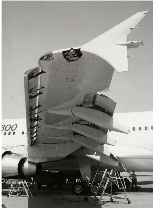
Slika 1.3 Pretkrilca na zrakoplovu tipa Airbus A310-300
