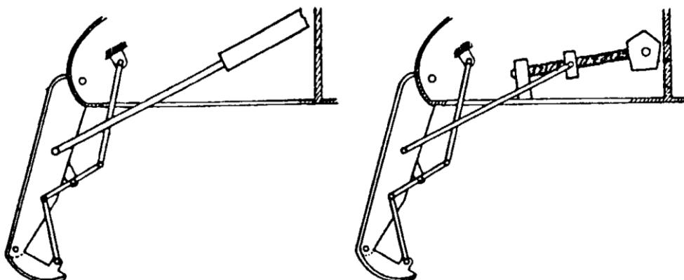
Slika 2.1 Usporedba hidrauličkog i mehaničkog mehanizma [1]
