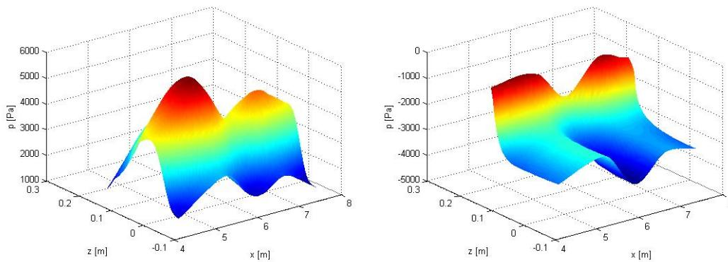
Slika 4.13 Raspodjela ukupnog tlaka po rasponu za  $\alpha=15^\circ$
