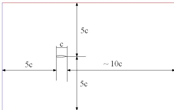
Slika 3.30 Dimenzije prostora strujanja za 2D model
