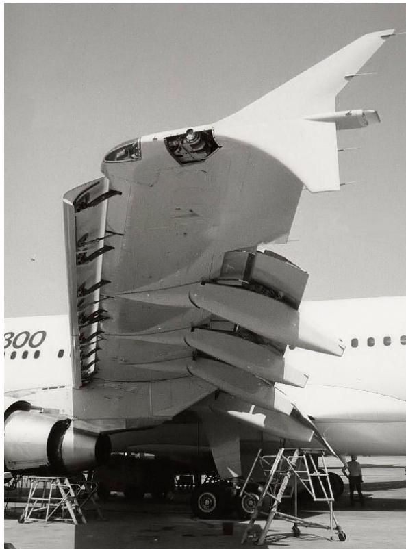
Slika 1.3 Pretkrilca na zrakoplovu tipa Airbus A310-300
