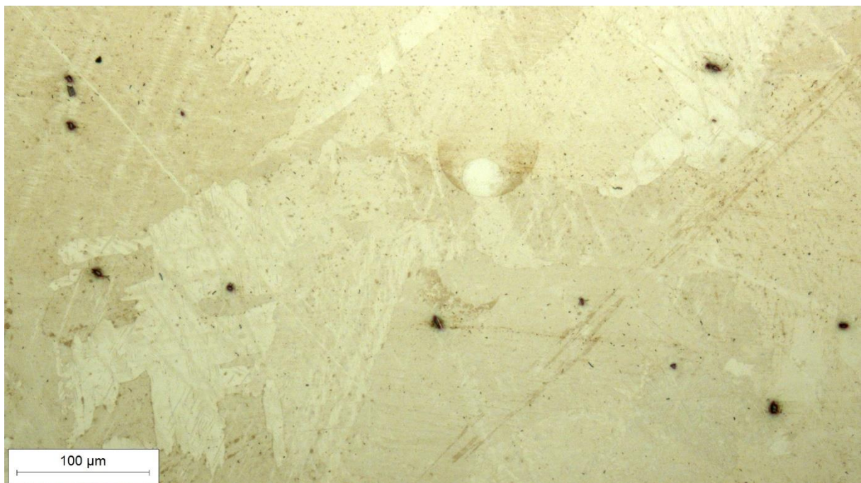
Slika 46. Mikrostruktura metala zavara u sredini zavara, nagrizenog stanje, snimljeno pri povećanju 200×
