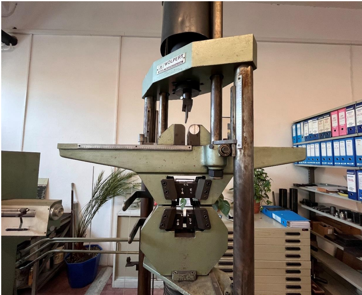
Slika 21. Kidalica prilagođena za savojno ispitivanje
