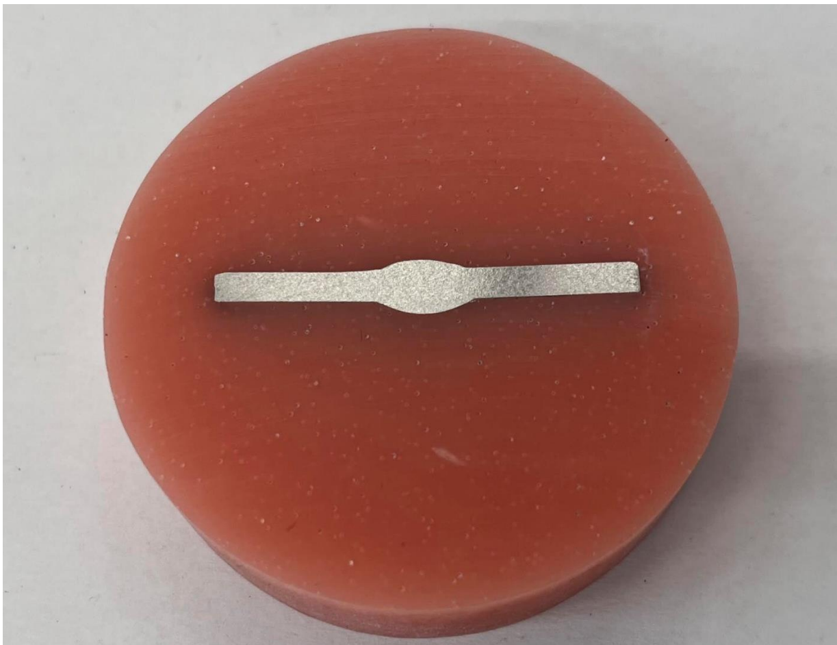
Slika 29. Makrostruktura zavarenog spoja prije procesa nagrivanja
