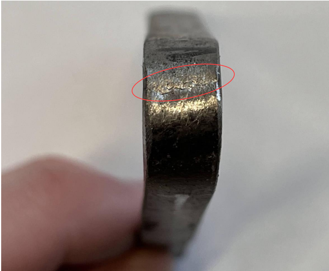
Slika 25. Mikropukotine na licu zavara ispitnog uzorka ispitivanog savijanjem
