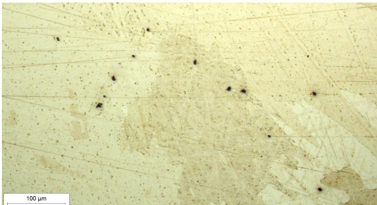
Slika 42. Mikrostruktura ZUT-a u sredini zavara, lijevo, snimljeno pri povećanju 200×
