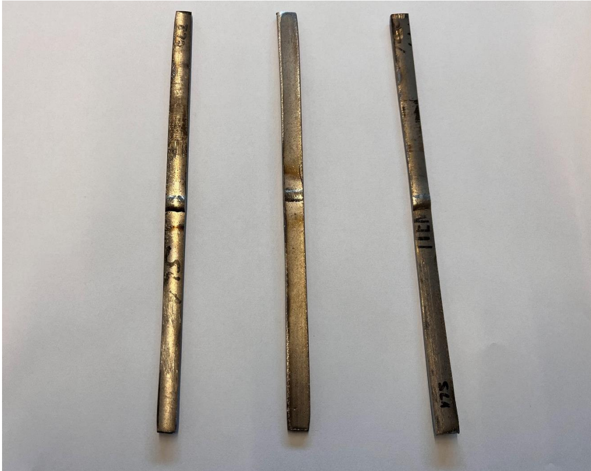
Slika 22. Pripremljeni uzorci za savojno ispitivanje
