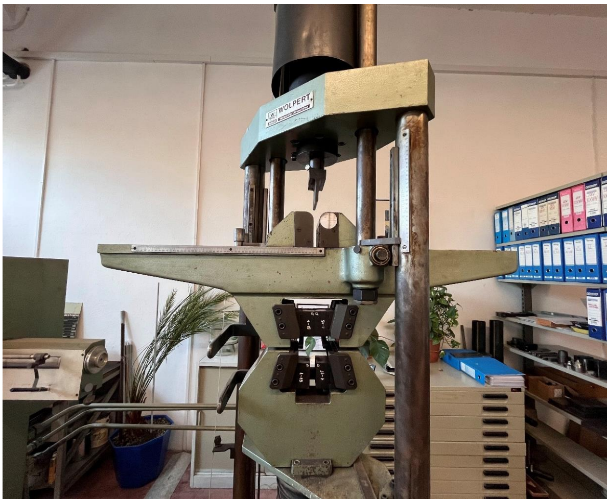
Slika 21. Kidalica prilagođena za savojno ispitivanje
