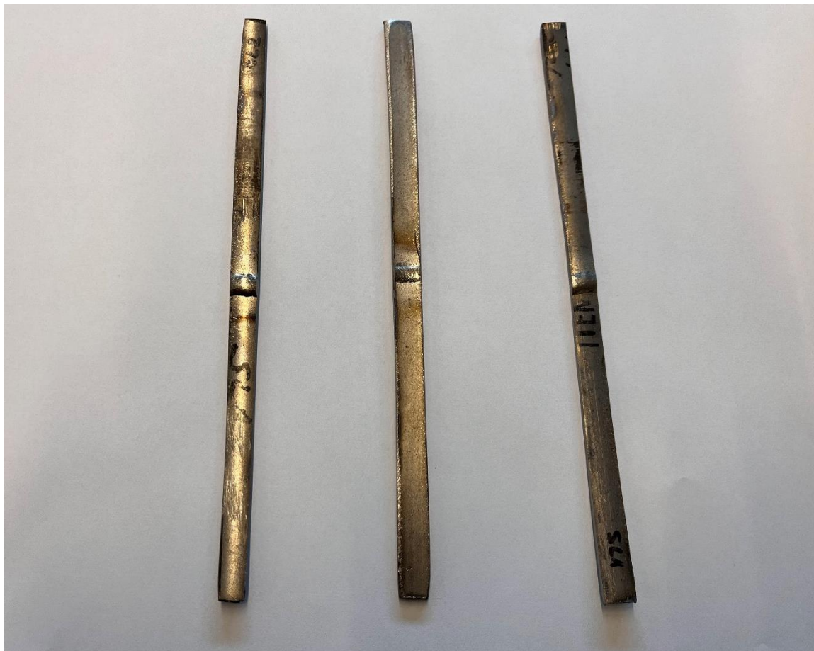
Slika 22. Pripremljeni uzorci za savojno ispitivanje
