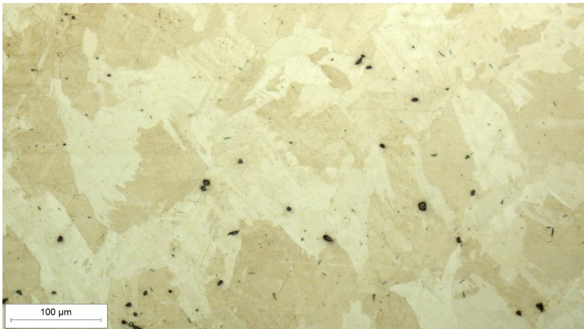
Slika 40. Mikrostruktura niskotemperaturnog ZUT-a u sredini zavara, snimljeno pri povećanju 200×
