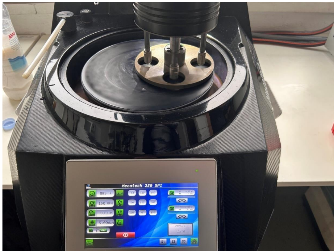
Slika 32. Postupak brušenja uzorka na uređaju Mecatech 250 SPI
