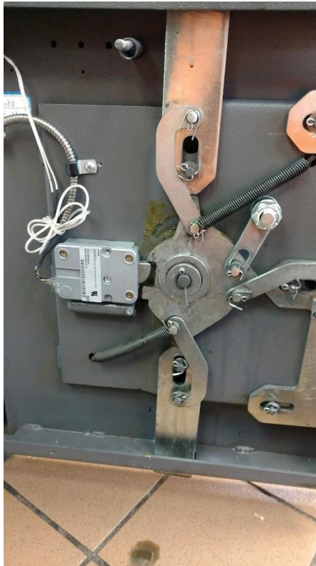
Slika 3.4 Pokretanje zasuna preko zglobova [17]
