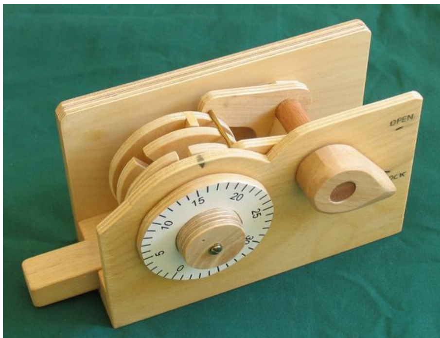
Slika 2.5 Ilustrativni primjer mehaničke sigurnosne brave [7]
