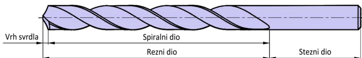
Slika 1.3. Dijelovi spiralnog svrdla [3]
