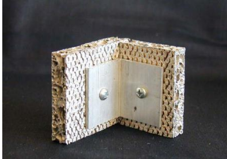
Slika 3.1. Primjeri rastavljivog spajanja metalnih pjena, [5]
