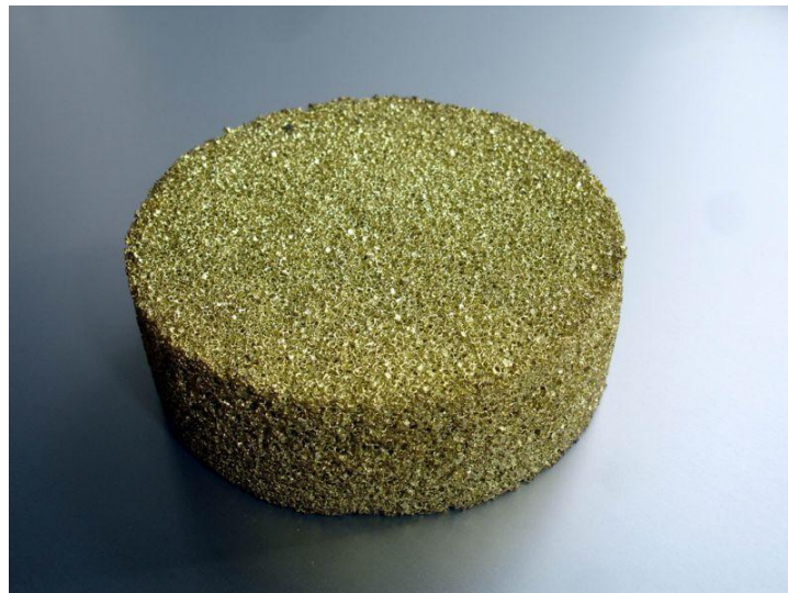
Slika 4.10. Filter od metalne pjene na bazi bronce [5]
