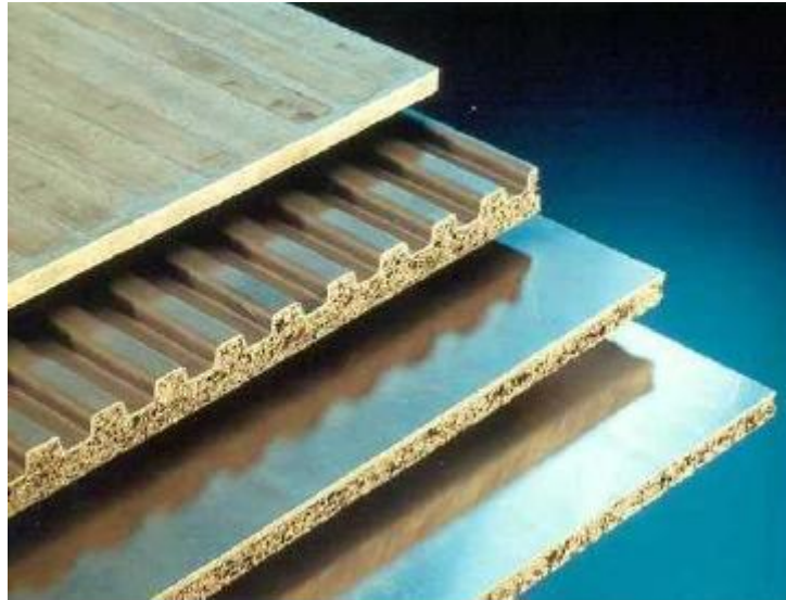
Slika 4.1. Primjer sendvič-konstrukcije s jezgrom od metalne pjene [5]
