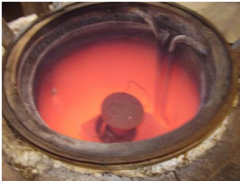
Slika 6.3. Kalup u peći na 850 Celzijusa
