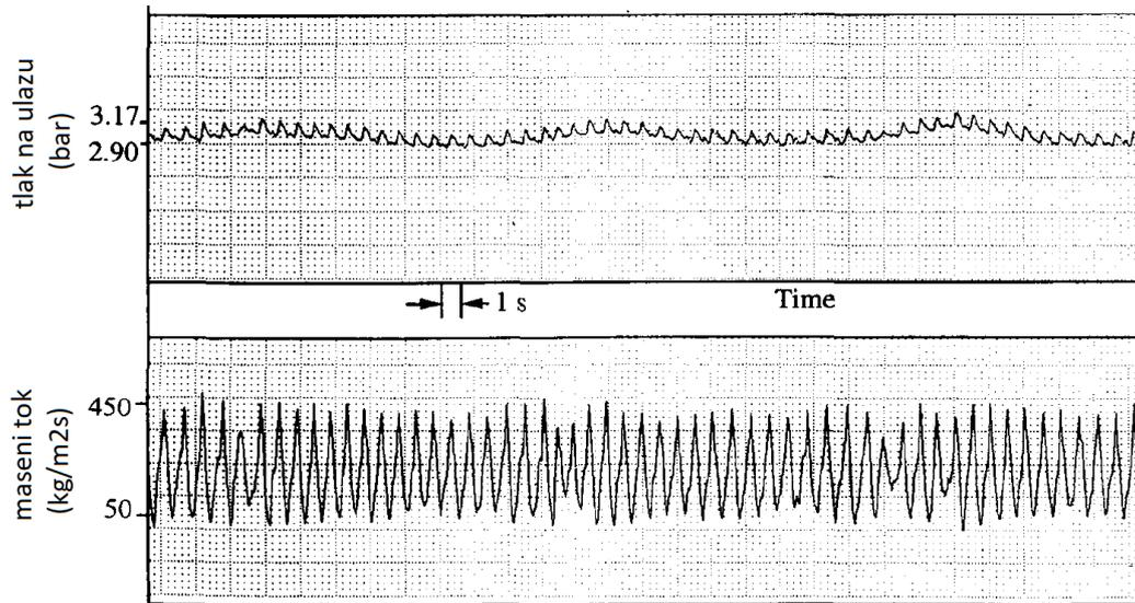
Slika 3.5: Mjerene vrijednosti tlaka na ulazu i masenog protoka na ulazu pri analizi oscilacija vala gustoće, preuzeto iz [4].
