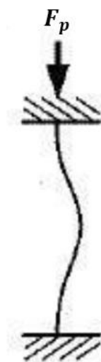
Slika 29. Model izvijanja za slučaj s uklještenjem na oba kraja
