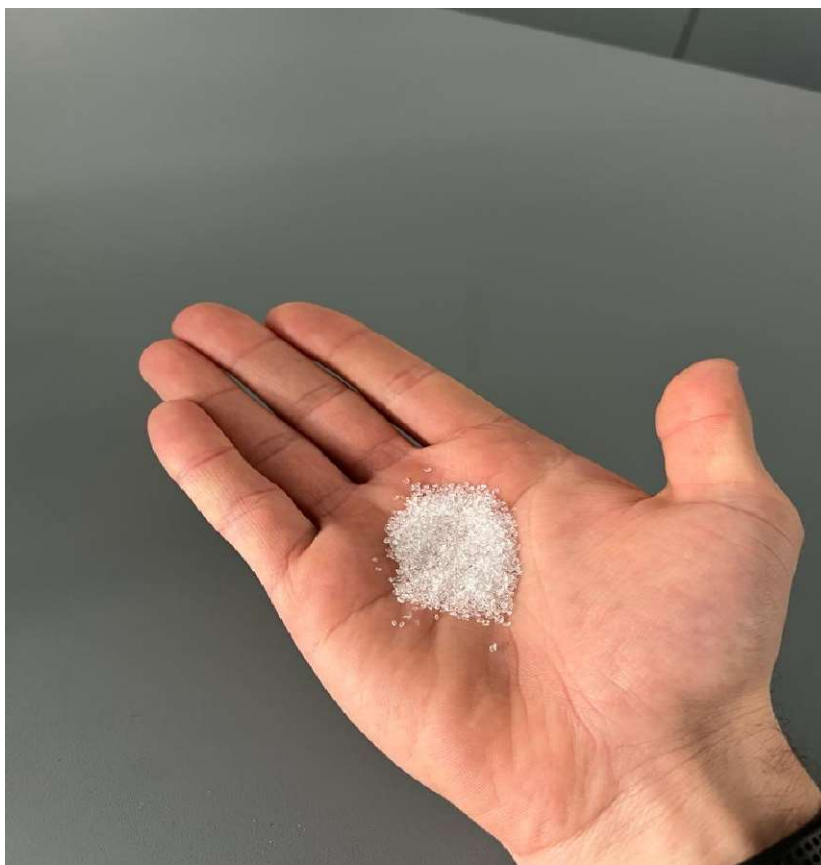
Slika 3 Staklena ispuna, filtracijski sloj
