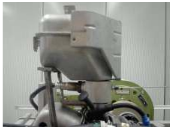
Slika 6.6. Spajanje lamdba sonde i termopara sa ispuhom
