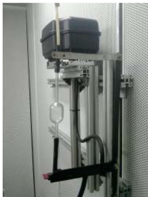
Slika 10.13. Cjelokupni sustav mjerača protoka goriva
