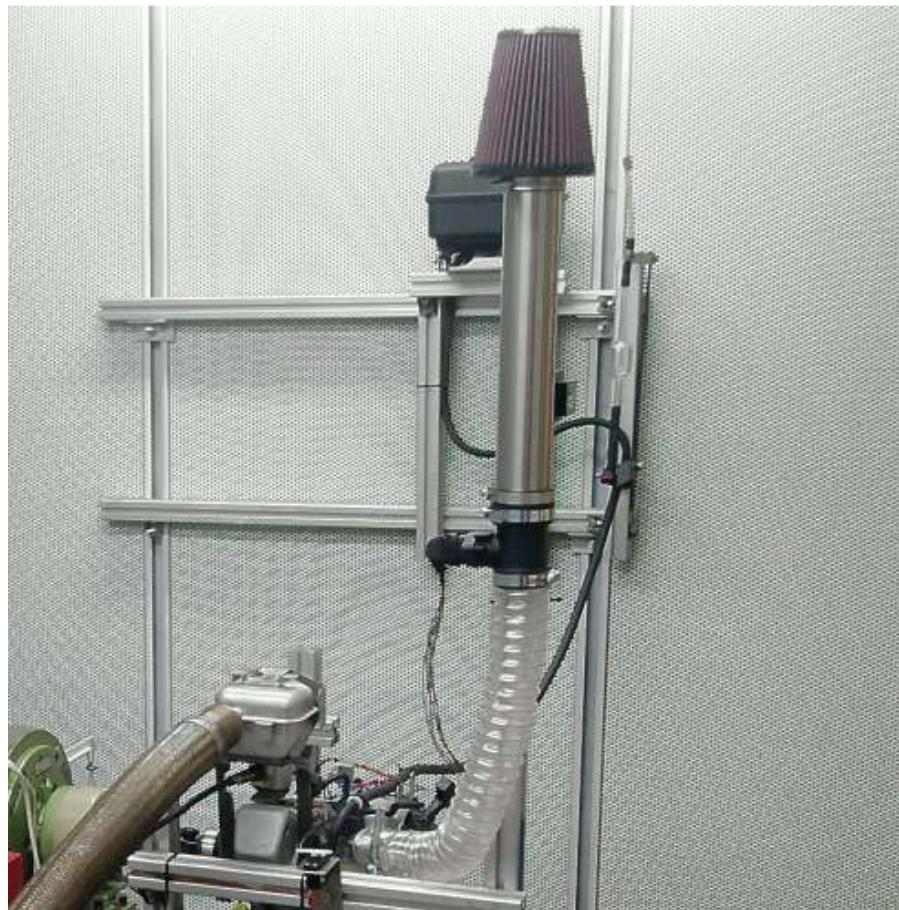
Slika 10.12. Cjelokupni sustav mjerača protoka zraka
