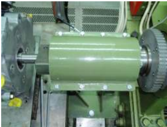
Slika 6.3. Montiranje zaštitnog poklopca
