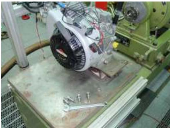
Slika 6.1. Montiranje motora
