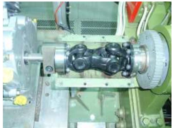
Slika 6.2. Montiranje spojnog vratila
