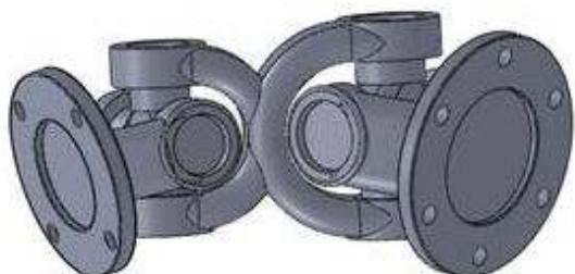
Slika 5.4. 3D model spojnjog vratila
