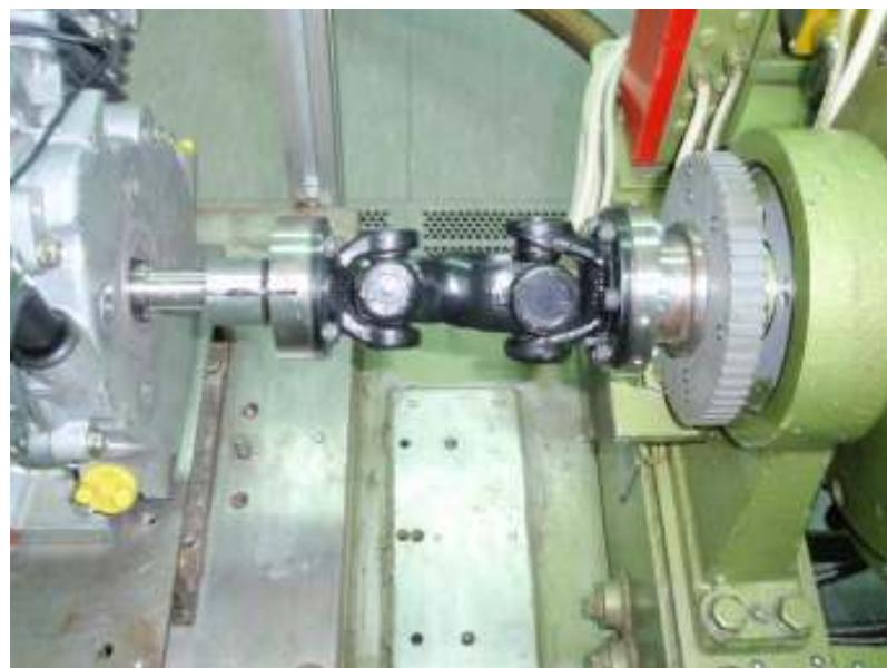
Slika 5.7. Montirano spojno vratilo na motor i kočnicu
