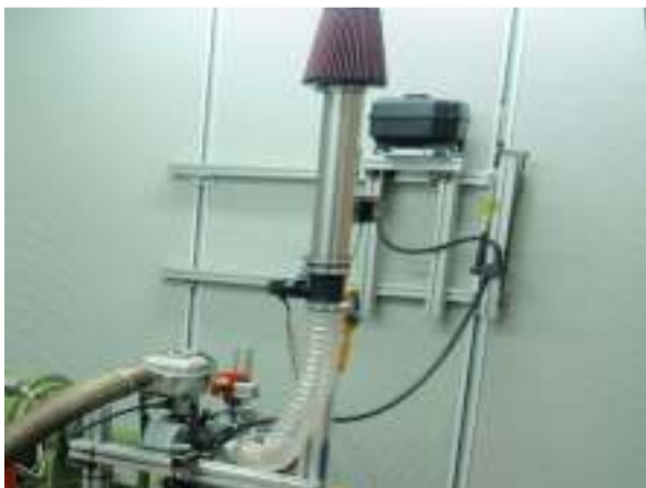
Slika 6.5. Spajanje sustava goriva, anemometra te ispušne cijevi sa motorom
