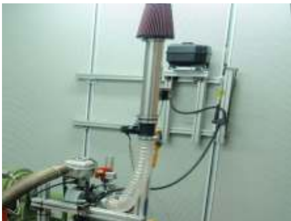
Slika 6.5. Spajanje sustava goriva, anemometra te ispušne cijevi sa motorom
