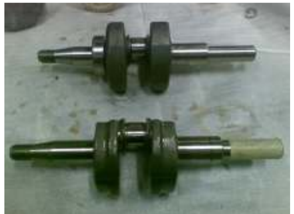
Slika 3.7. Novo koljenasto vratilo (gore)
