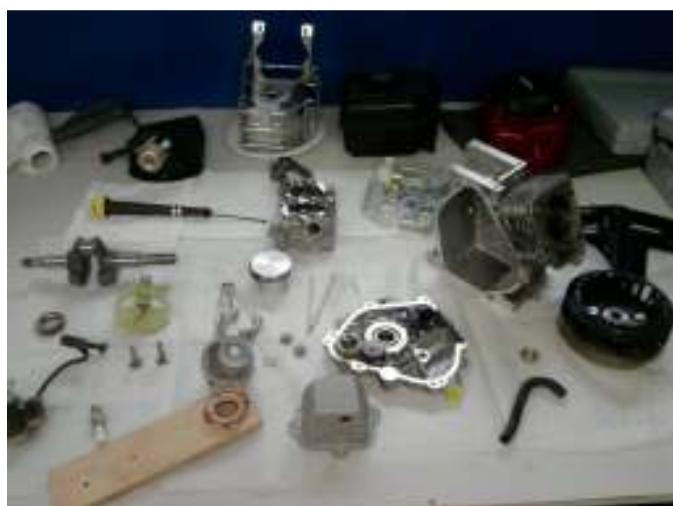
Slika 3.3. Dijelovi rastavljenog motora
