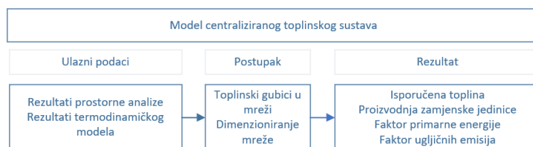
Slika 19: Shema modela centraliziranog toplinskog sustava
