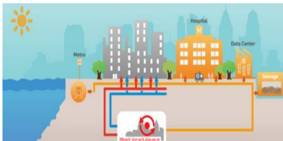
Slika 4: Shema iskorištavanja topline iz urbanih toplinskih izvora [6]
