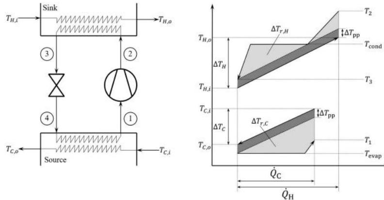
Slika 20: Shematski prikaz rada dizalice topline [27]
