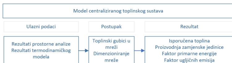
Slika 19: Shema modela centraliziranog toplinskog sustava
