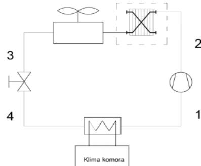
Slika 15: Shematski prikaz ljevokretnog procesa
