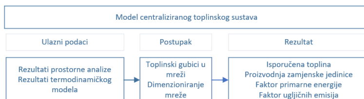
Slika 19: Shema modela centraliziranog toplinskog sustava
