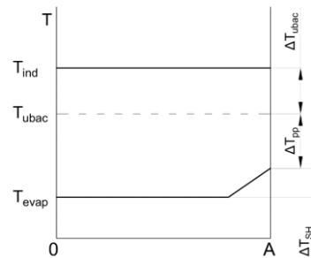
Slika 16: Načelna shema prijenosa topline na granici sustava klima komore i radne tvari
