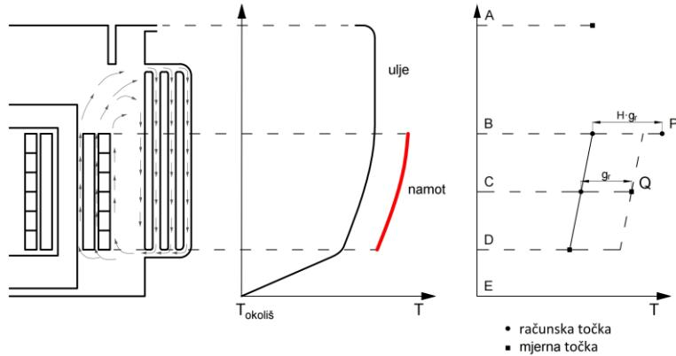
**Slika 18: Načelna shema temperaturne stratifikacije u transformatoru te prikaz ključnih temperaturnih točaka [18]**
