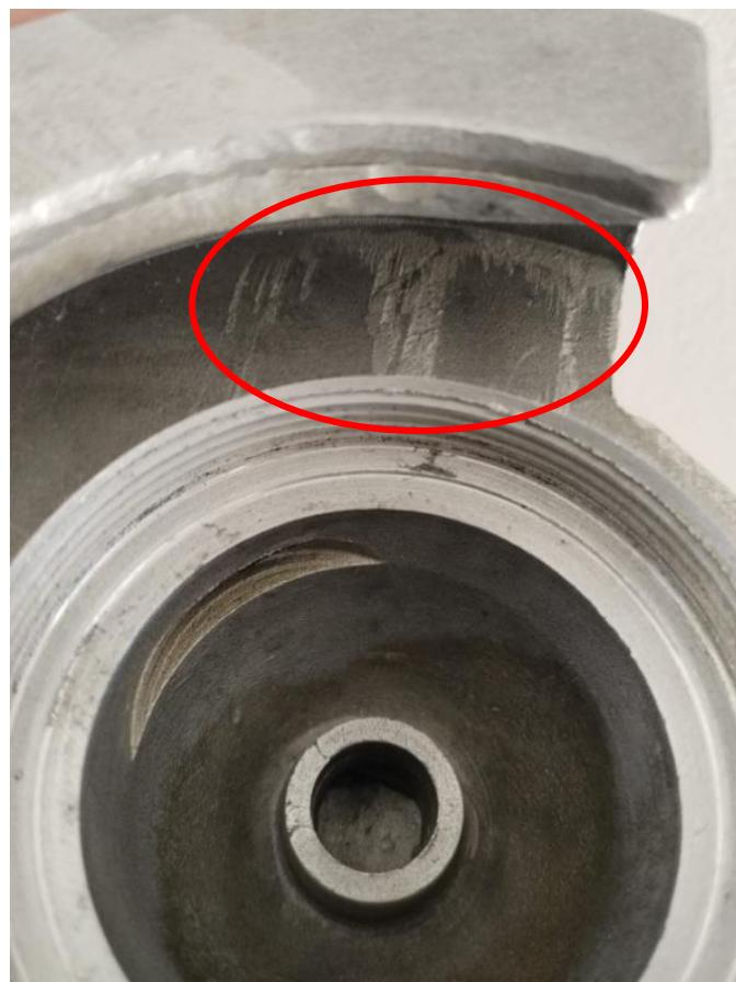
**Slika 9. Ostrugana površina na odljevku uslijed zaribavanja alata**
