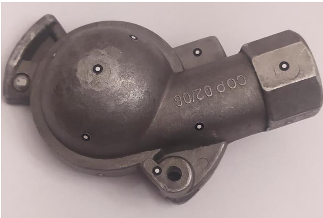
Slika 12. Odljevak spreman za skeniranje
