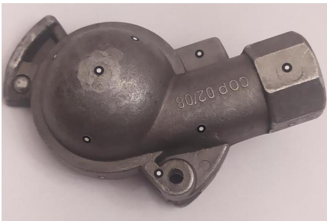
Slika 12. Odljevak spremam za skeniranje
