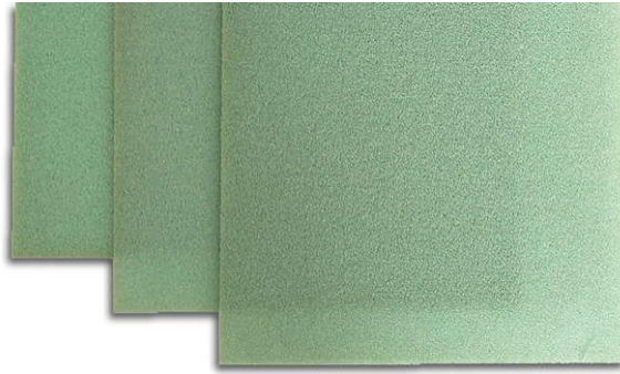
Slika 9 Mycell M80 (Airex) [3]
