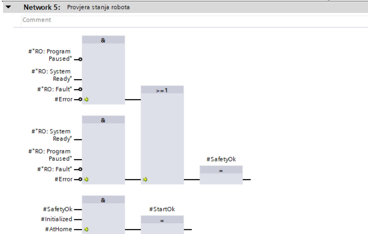
Slika 55. Logika za provjeru stanja Fanuc robota
