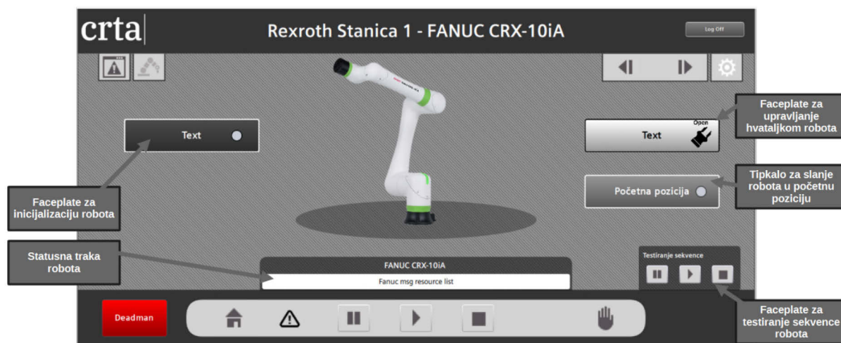
Slika 58. Potpuno definirani zaslon Fanuc CRX-10iA robota
