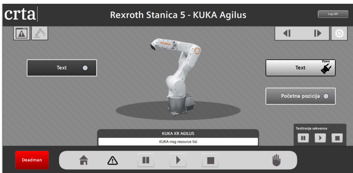
Slika 85. Potpuno definirani zaslon KUKA Agilus robota
