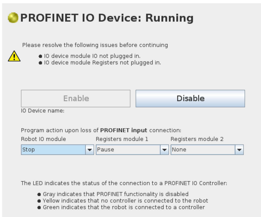
Slika 62. Konfiguracija PROFINET-a na UR robotu
