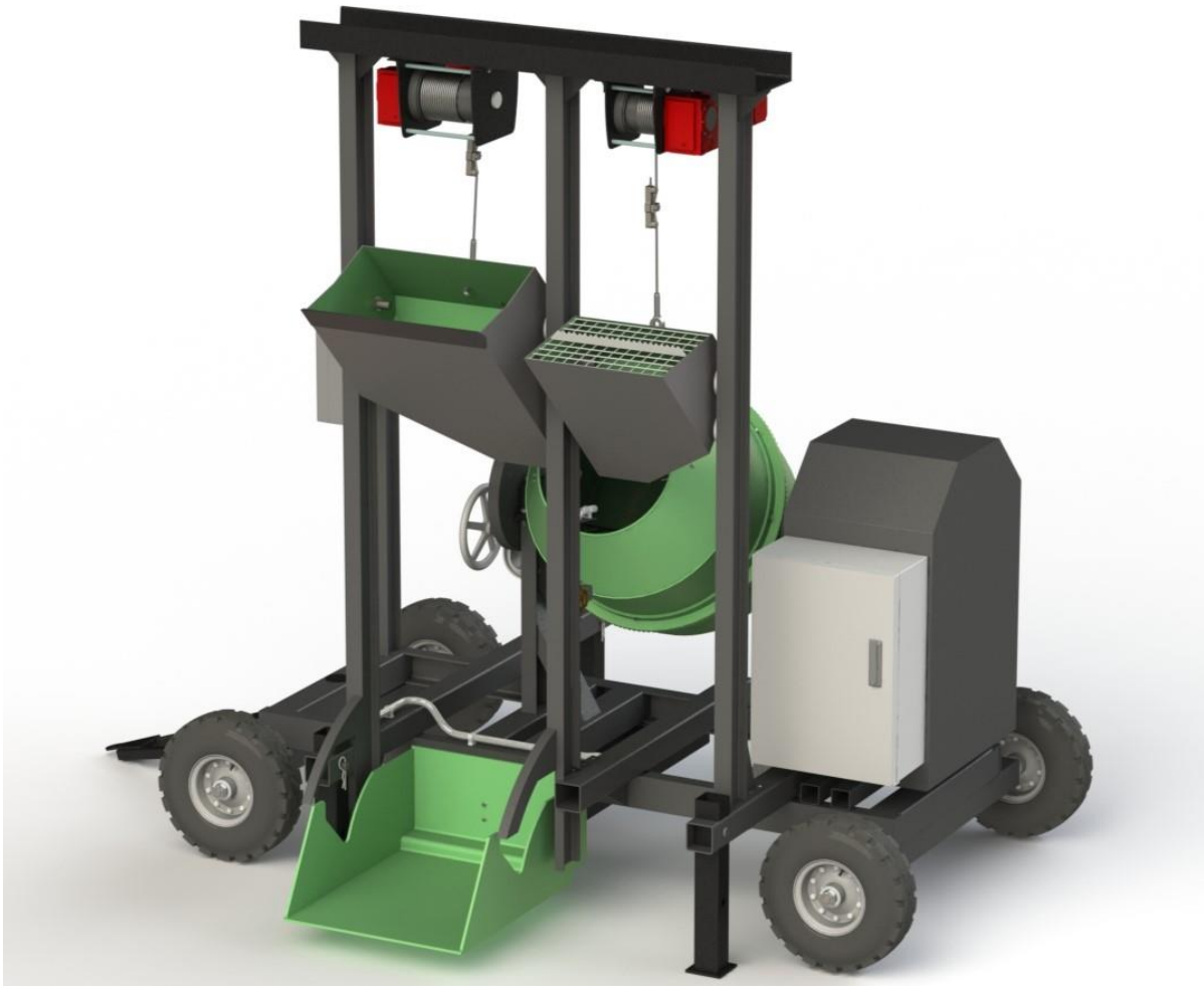
Slika 38. Mehanizam podizanja i spuštanja spremnika
