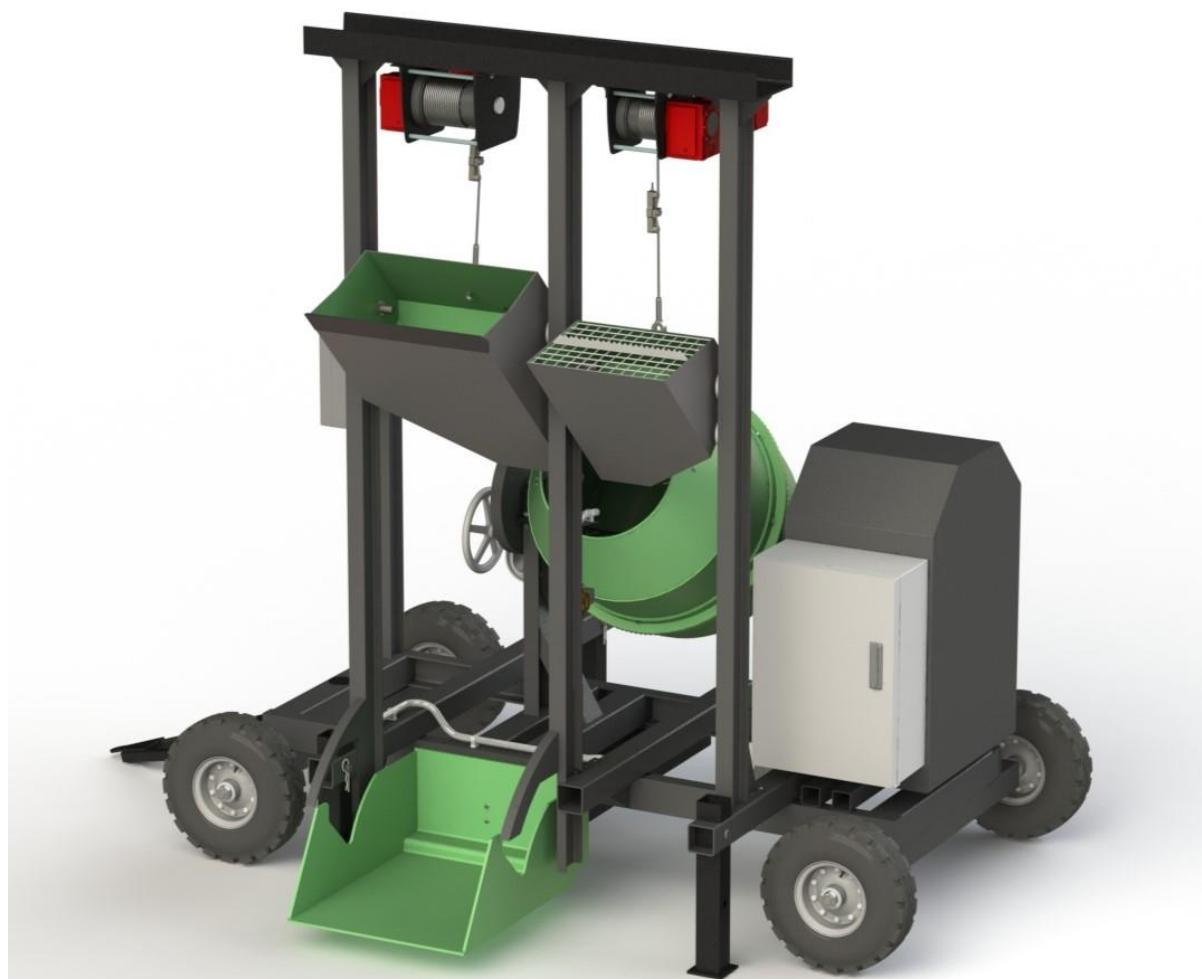
Slika 38. Mehanizam podizanja i spuštanja spremnika
