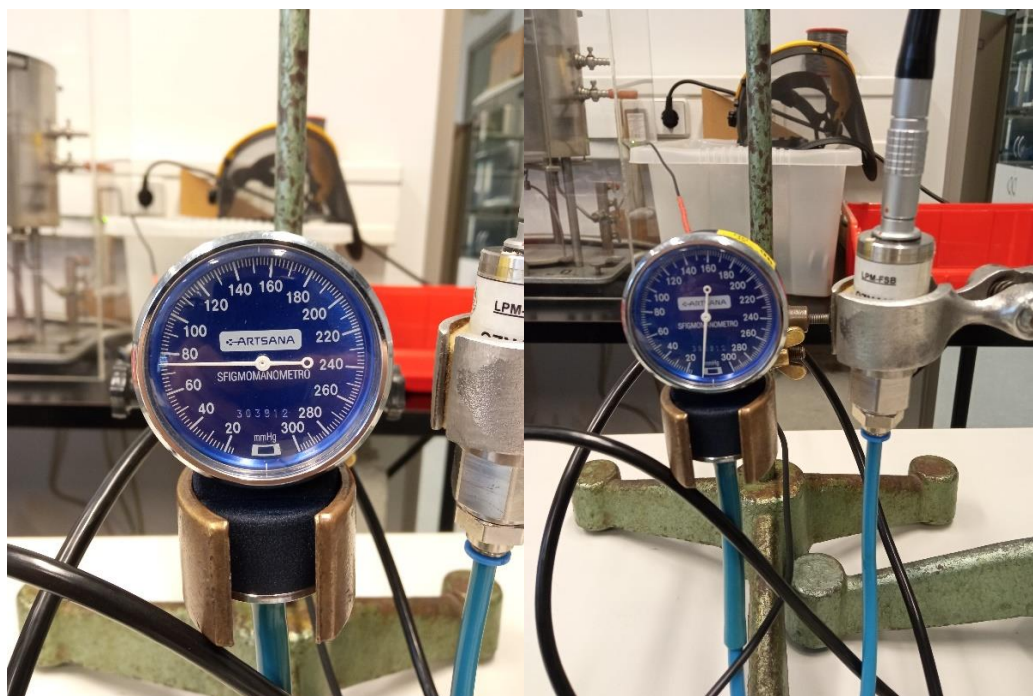
Slika 24. Prikaz ispitivanog mehaničkog sfigmomanometra
