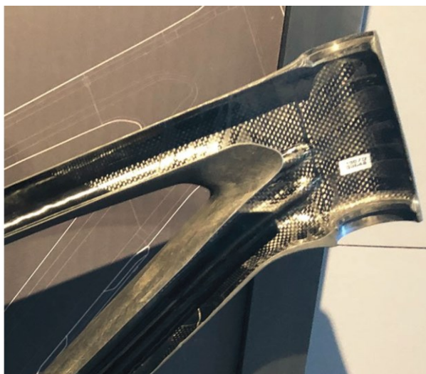
Slika 54 Presjek analiziranog i stvarnog [29] kompozitnog okvira
