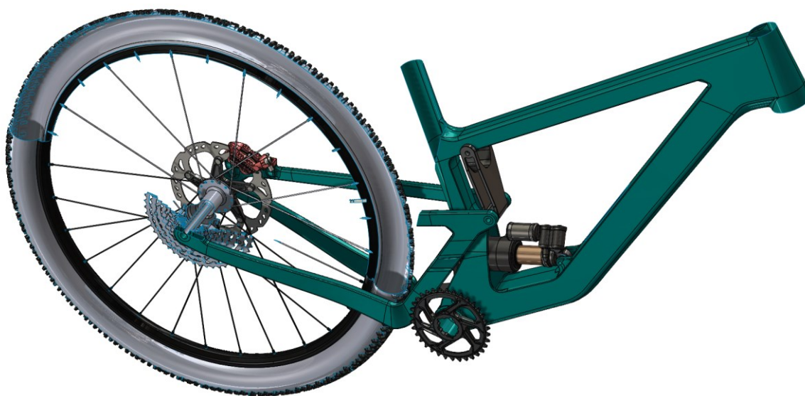
Slika 26 Okvir i referentne komponente prilikom modeliranja
