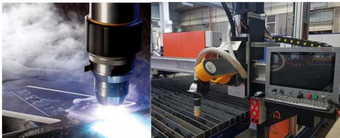
Slika 12. CNC plazma/plinska rezačica [10]
