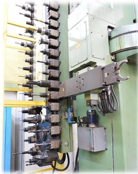
Slika 34. Lančano spremište alata: gore [8] dolje [24]
