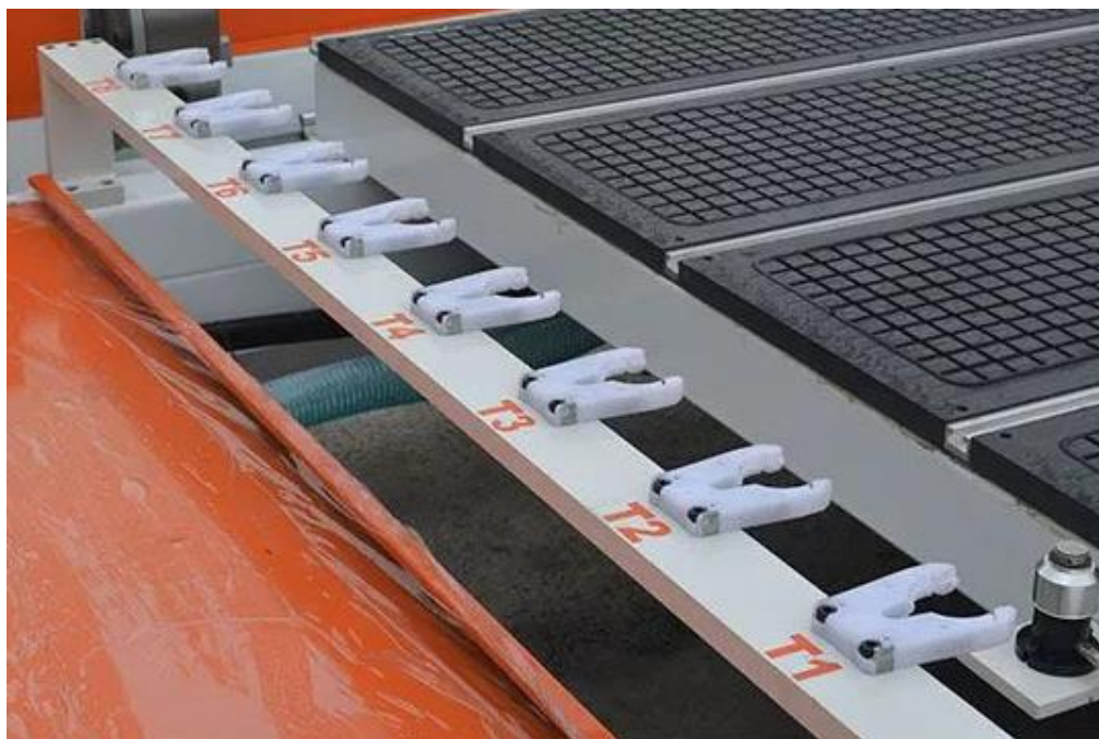
Slika 51. Prihvatnice držača alata na stalku pored postolja obradnog centra [33]
