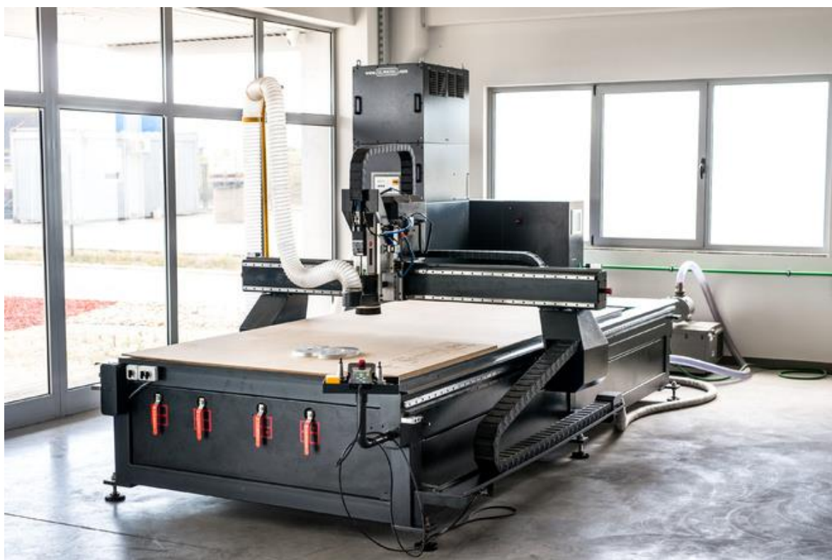
Slika 11. CNC portalna glodalica [9]
