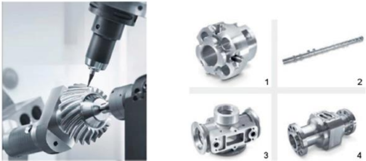
Slika 23. Lijevo: istodobno glodanje konusnog zupčanika; Desno: različiti izratci za automobilsku industriju proizvedeni na istom obradnom sustavu: 1 – kalupni element, 2 – koljenasto vratilo, 3 -kućište ventila, 4 – dio priključka za koljenasto vratilo [19]
