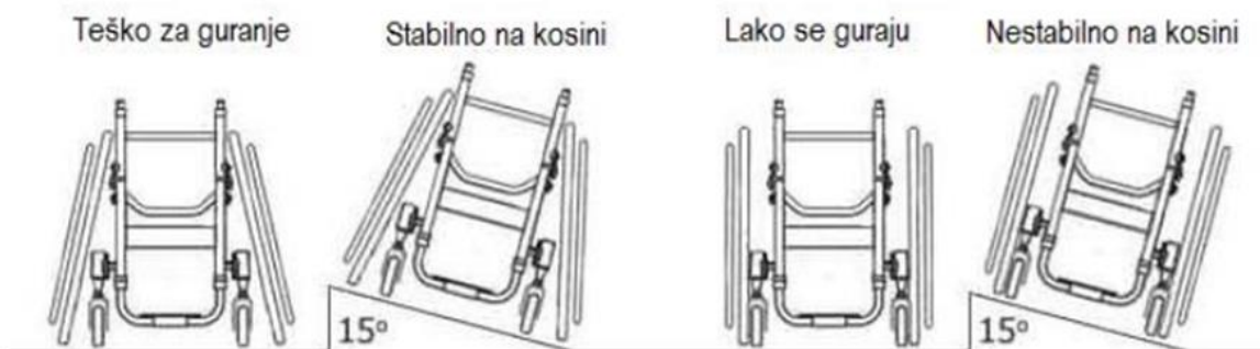
Slika 12. Bočna stabilnost sa ukošenim kotačima s obzirom na ukošeni teren [16]
