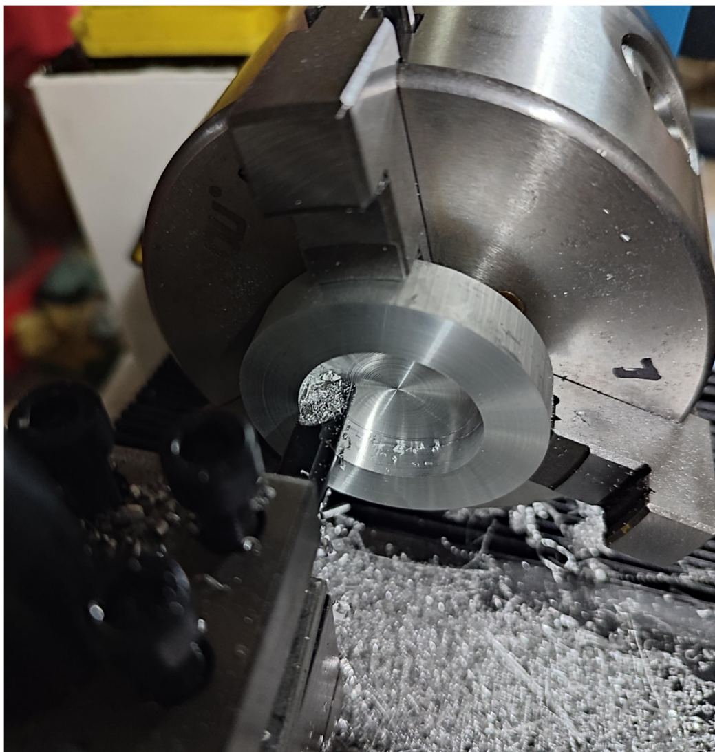
Slika 33 Izrada ležajnih mjesta, istokarivanje (crtež broj 01-01-02)
