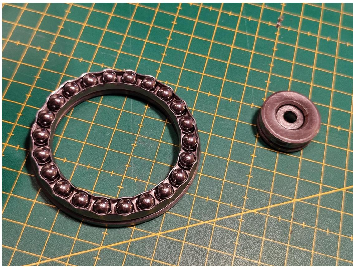
**Slika 31 Ležajevi korišteni u rotacijskom dijelu**
