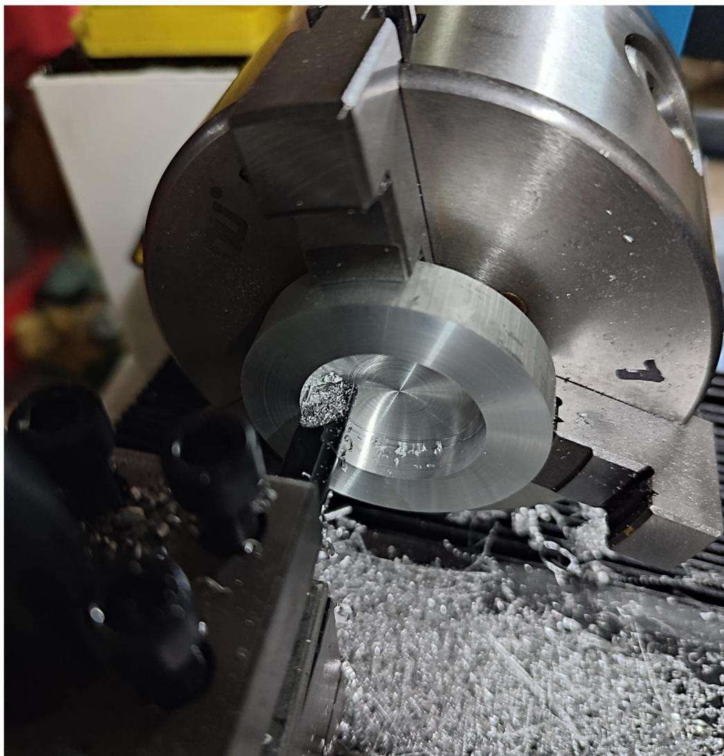
**Slika 33 Izrada ležajnih mjesta, istokarivanje (crtež broj 01-01-02)**
