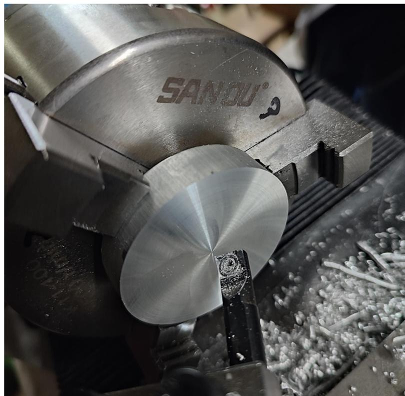
Slika 32 Izrada ležajnih mjesto, operacija poprečnog tokarenja (facing) (crtež broj 01-01-02)
