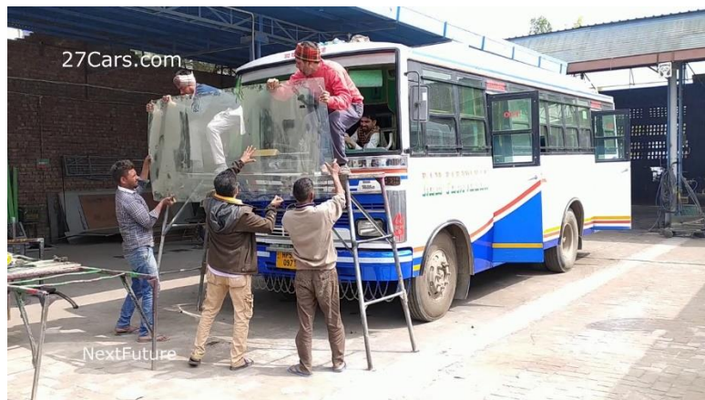
Slika 2.3. Postavljenje vjetrobranskog stakla na autobus [6]
