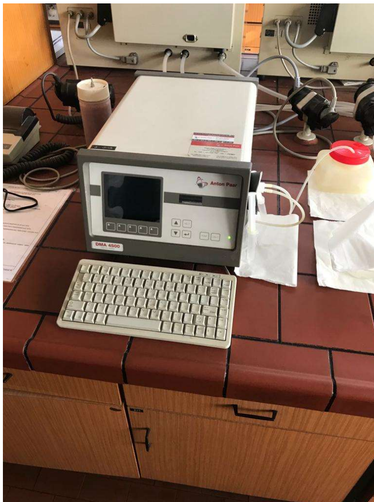
Slika 10. Automatski uređaj za određivanje gustoće
