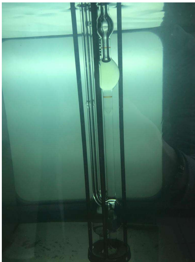
Slika 9. Krupni plan kapilare unutar kapilarnog viskozimetra
