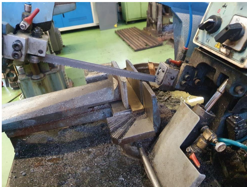
Slika 13. Rezanje uzoraka na strojnoj pili
