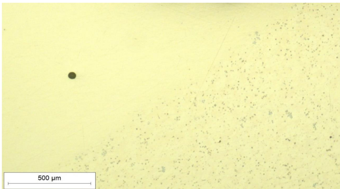
Slika 21. Metal navara i zona utjecaja topline u poliranom stanju
