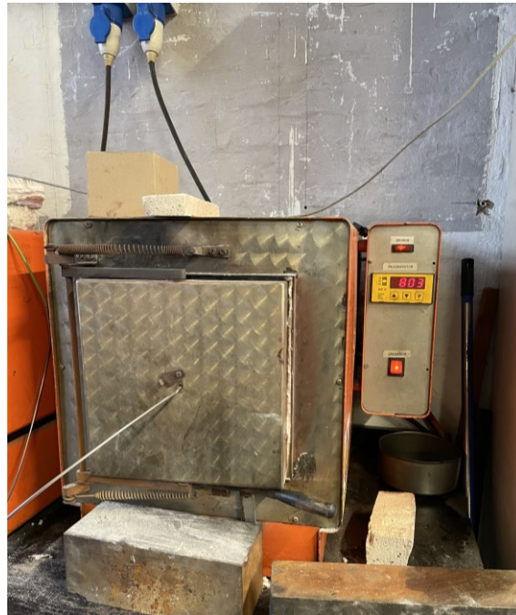
Slika 24. Električna laboratorijska peć u Laboratoriju za toplinsku obradu Fakulteta strojarstva i brodogradnje
