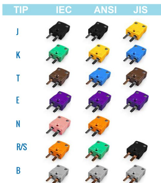
Slika 21. Medunarodne boje konektora termoelementa [34]
