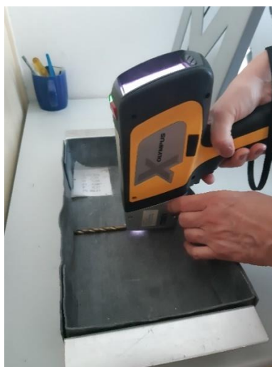
Slika 20. Ispitivanje kemijskog sastava svrdla XRF uređajem
