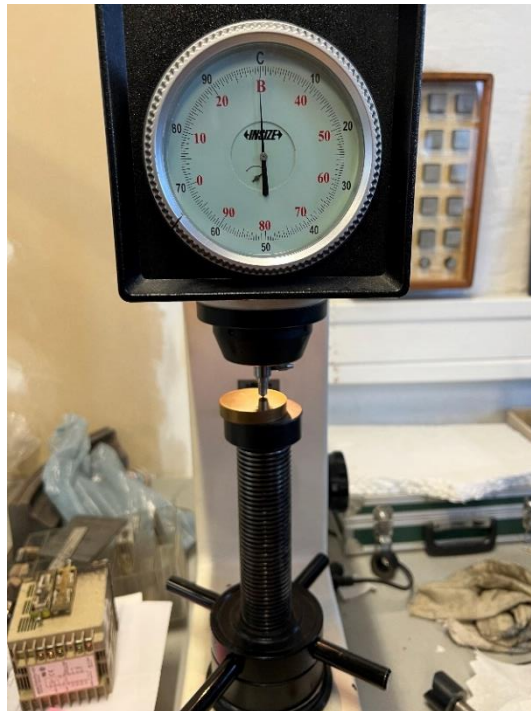
Slika 32. Utiskivanje Rockwell C indentora u prevlaku TiN
