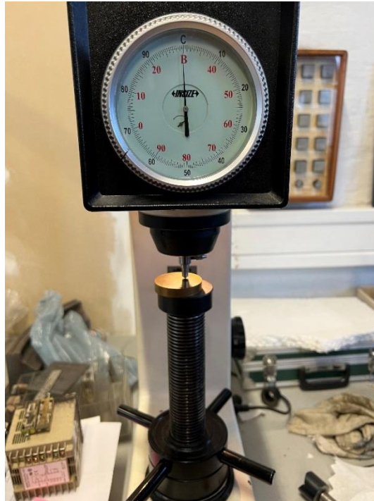
Slika 32. Utiskivanje Rockwell C indentora u prevlaku TiN
