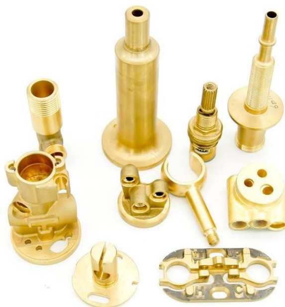
Slika 15. Konstrukcijski dijelovi prevučeni prevlakom titan nitrida
