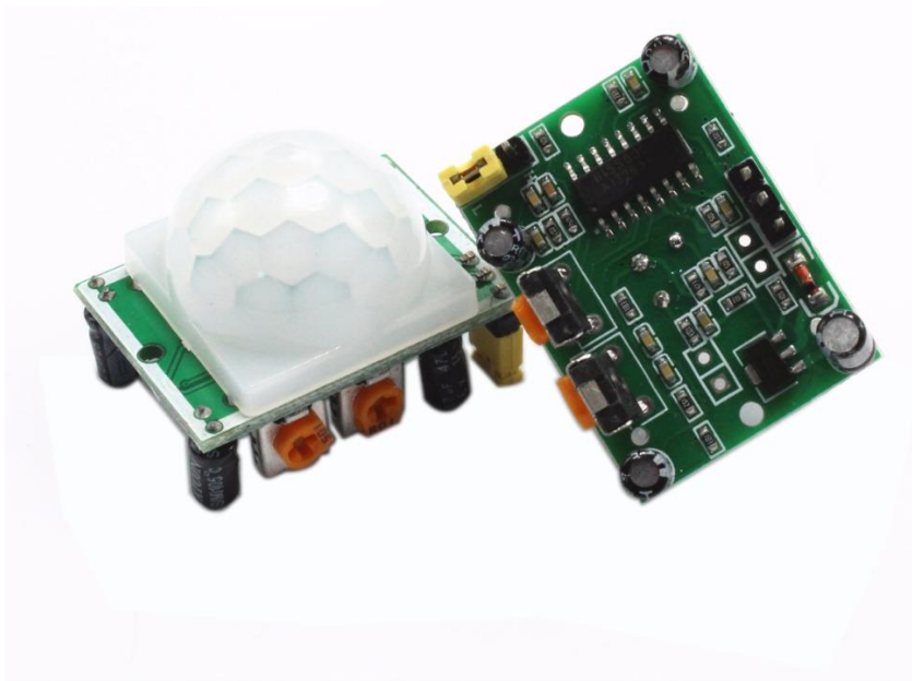
Slika 4. Senzor pokreta oznake HC-SR501 [ 2 ]
