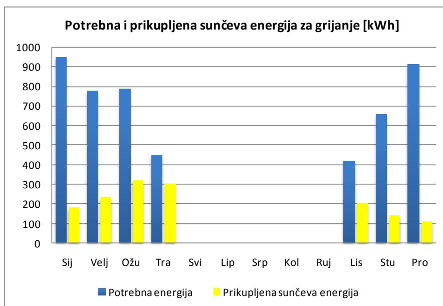
Slika 5.13 Grafički prikaz mjesecnih energetskih potreba i sunčanog dobitka za grijanje, Zagreb, niskoenergetska gradnja, 8m<sup>2</sup>-200l
