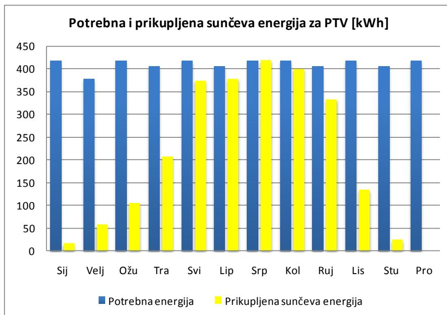
Slika 5.12 Grafički prikaz mjesecnih energetskih potreba i sunčanog dobitka za PTV, Zagreb, niskoenergetska gradnja, 8m<sup>2</sup>-200l
