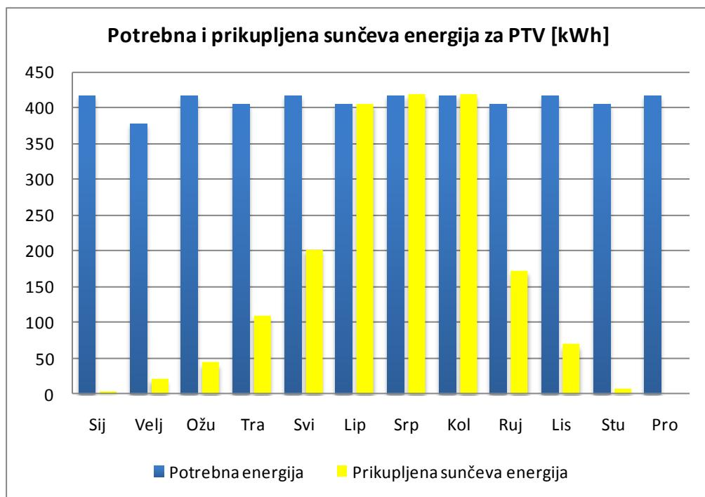
Slika 5.9 Grafički prikaz mjesecačnih energetskih potreba i sunčanog dobitka za PTV, Zagreb, obična gradnja, 14m<sup>2</sup>-2001
