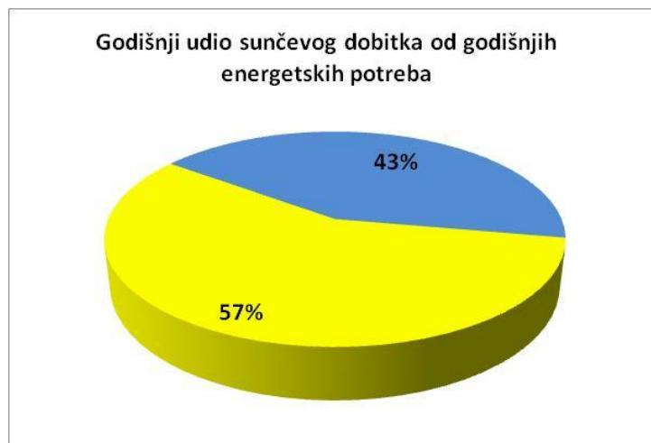
Slika 5.14 Udio godišnjeg energetskog dobitka sunčanog sustava od ukupnih godišnjih energetskih potreba, Zagreb, niskoenergetska gradnja, 8m<sup>2</sup>-200l
