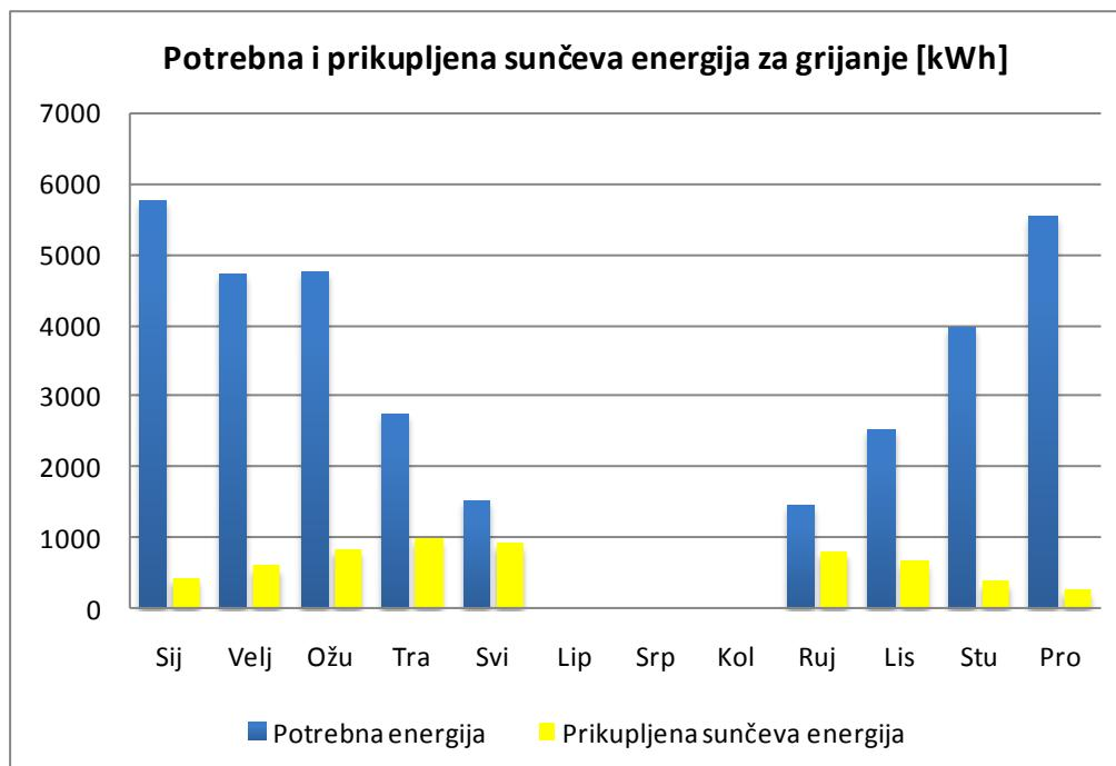
Slika 5.10 Grafički prikaz mjesecačnih energetskih potreba i sunčanog dobitka za grijanje, Zagreb, obična gradnja, 14m<sup>2</sup>-2001
