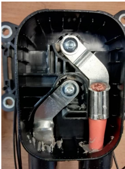
Slika 30. Unutarnji dio komponente bez vidljivih oštećenja
