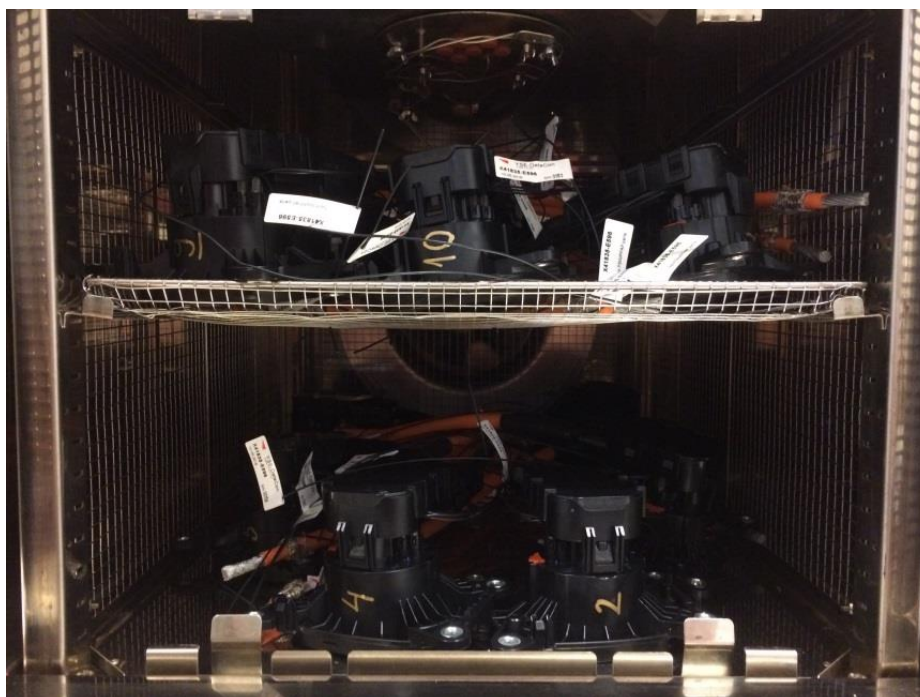
Slika 16. Ispitni predmeti položeni unutar šok komore
