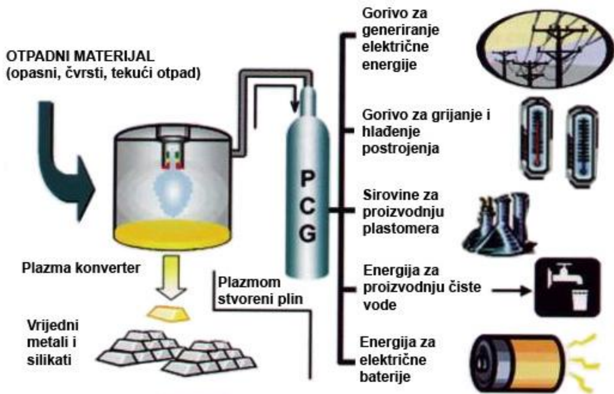
Slika 4.6. Shema rada plazma postrojenja [15]
