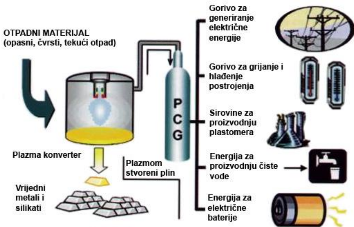
Slika 4.6. Shema rada plazma postrojenja [15]
