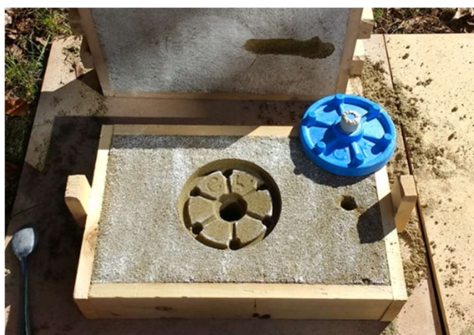
Slika 5. Prikaz izrade kalupne šupljine pomoću 3D printanog modela
