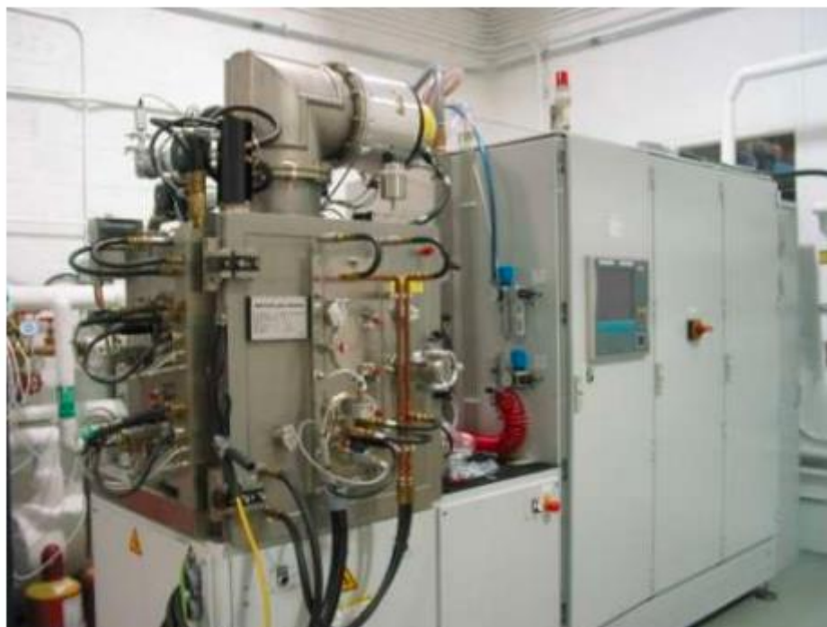
Slika 16. Uređaj za PVD prevlačenje
