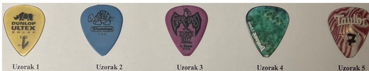
Slika 38. Uzorci trzalica nakon provedenog ispitivanja trošenja
