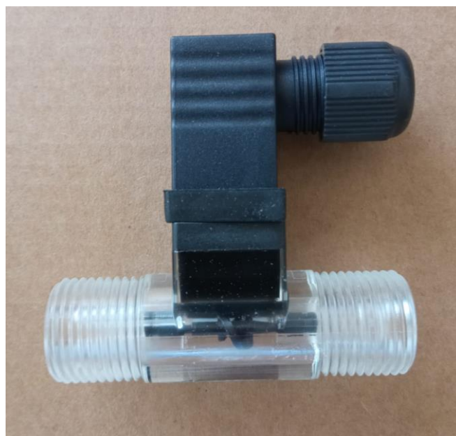
Slika 6. Protokomjer Badger Meter (3/8)
