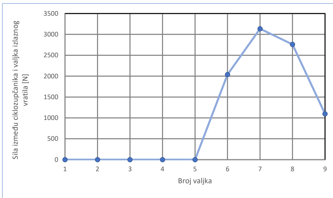
Slika 16. Raspodjela sila između ciklozupčanika i valjka izlaznog vratila za kut zakreta vratila 160°
