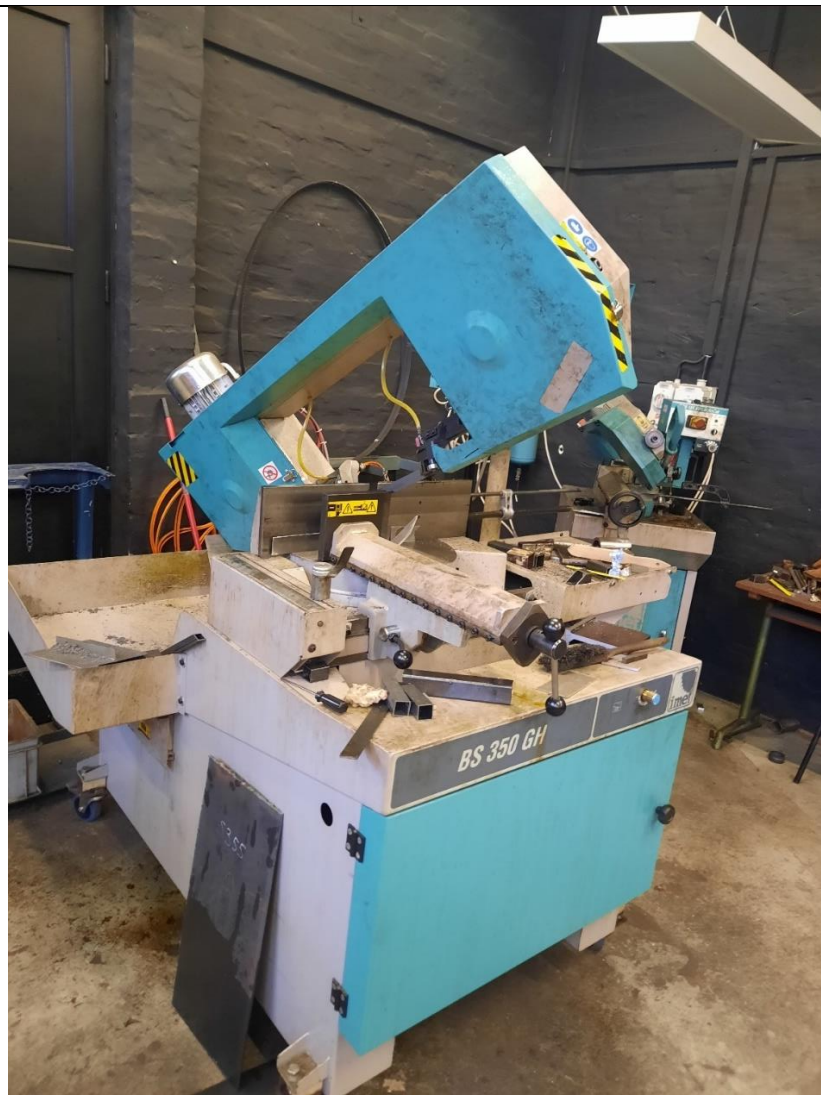
Slika 16. Tračna pila korištena za rezanje uzoraka
