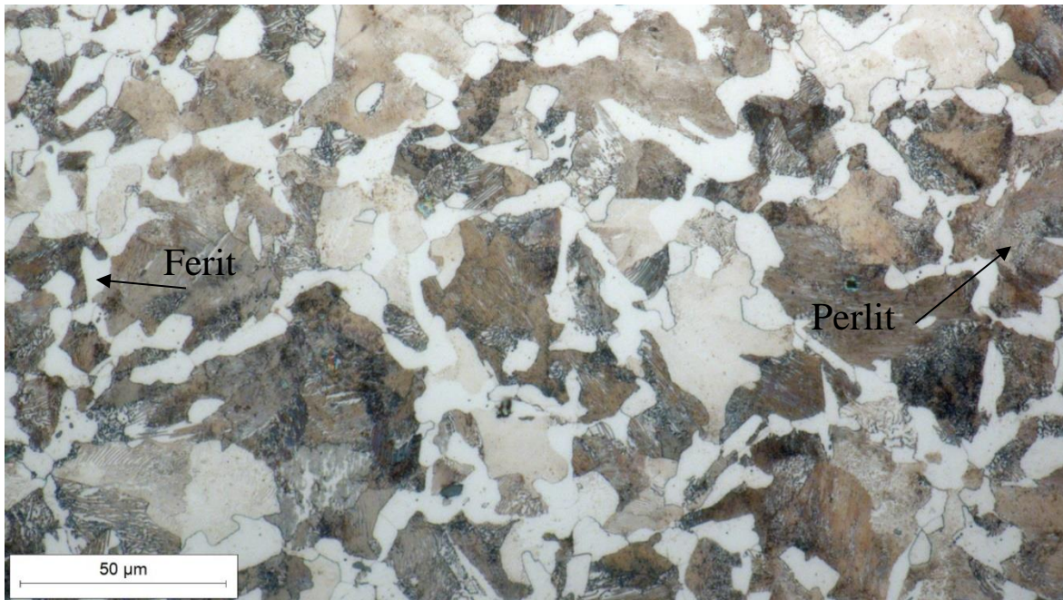
Slika 39. Mikrostruktura jezgre uzorka, povećanje 500x
