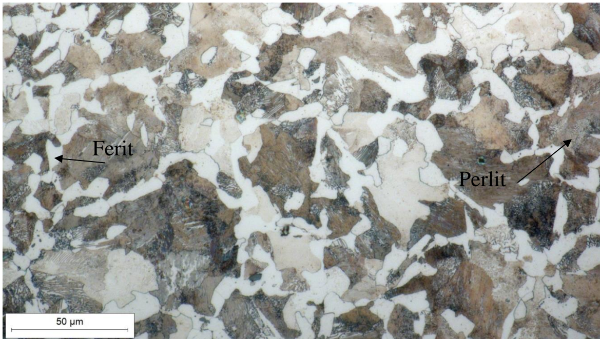
Slika 39. Mikrostruktura jezgre uzorka, povećanje 500x
