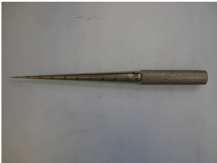
Slika 12. Mjerilo za mjerenje razmaka
