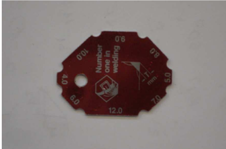
Slika 6. Mjerilo za provjeru debljine kutnog zavarenog spoja
