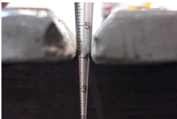
Slika 13. Mjerilo za mjerenje razmaka- pravilno postupanje
