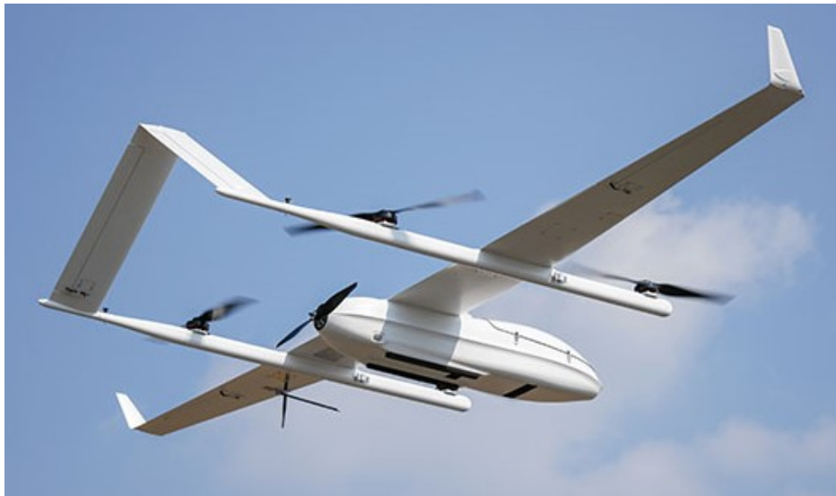
Slika 9. Primjer hibridne besposadne letjelice - CW-25E tvrtke JOUAV [22]
