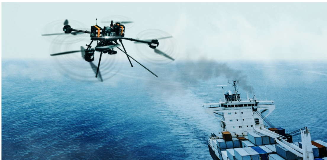
Slika 10. Besposadna višerotorna letjelica Staaker [23]
