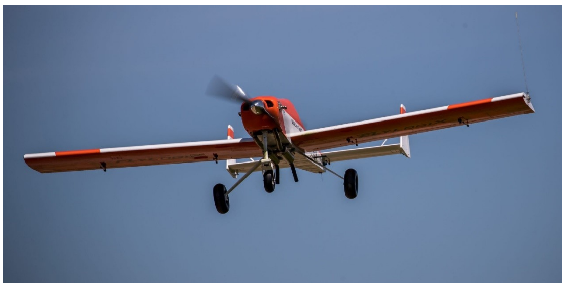
Slika 11. Besposadna letjelica s fiksnim krilima FX2 tvrtke Flylogix [24]
