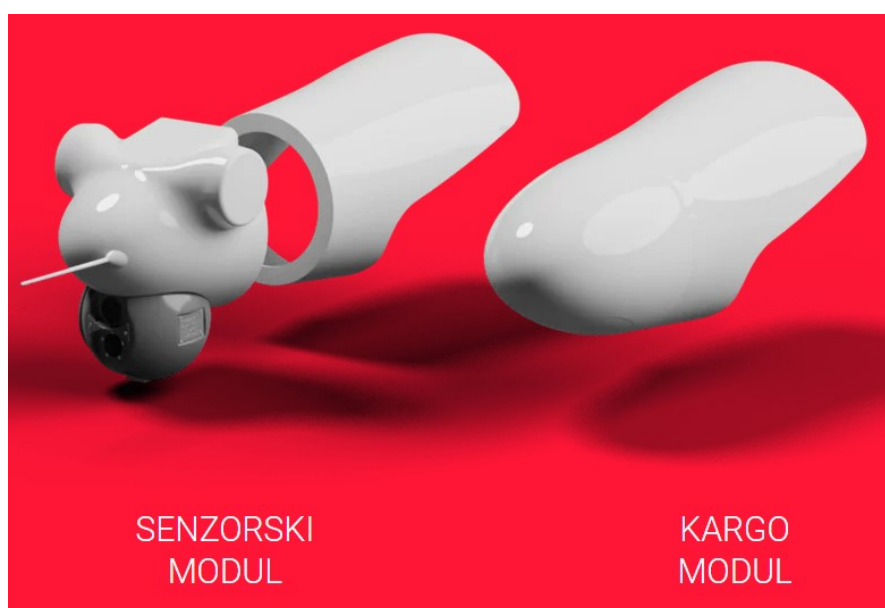
Slika 13. Konfiguracija senzorskog i kargo modula [27]
